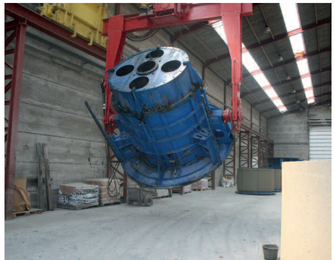
Во время транспортировки на станцию распалубки форму кантуют
