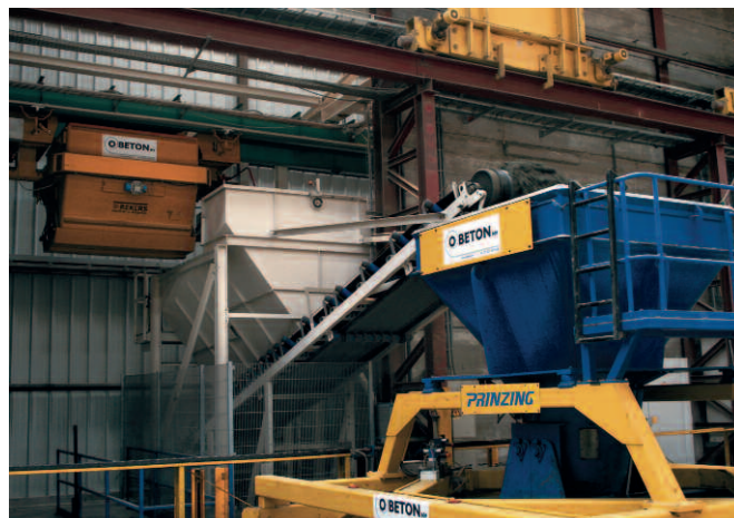
Установка Atlas снабжается жесткой бетонной смесью при помощи кубельной системы и бункера предварительного хранения
