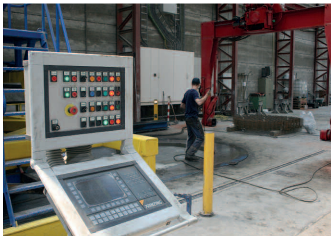
Панель управления с навигацией при помощи вкладок меню; управление всеми процессами ведется отсюда
