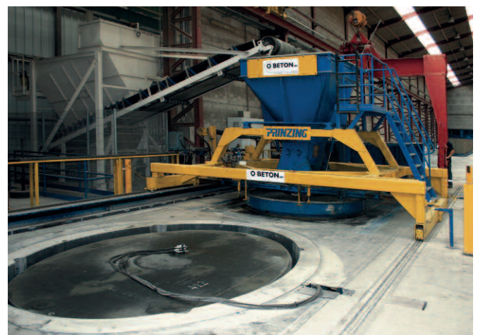
Производство на рабочей станции 1; бункер заполняется в центральном положении, в то время как рабочая станция 1 готовится к выпуску следующего изделия
