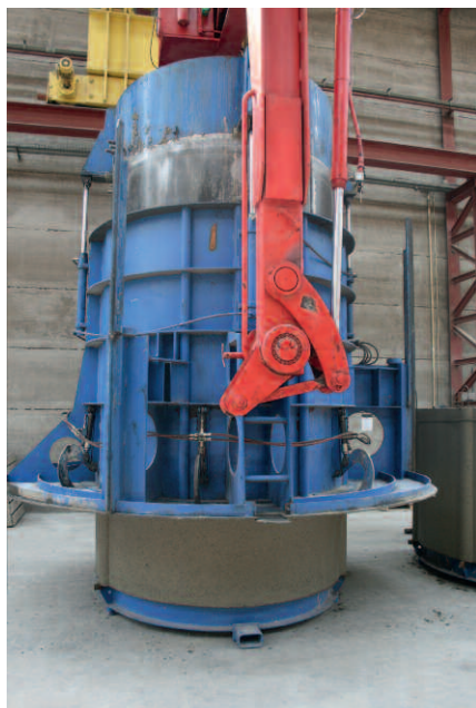
Весь процесс распалубки контролируется с подвешенного пульта управления
