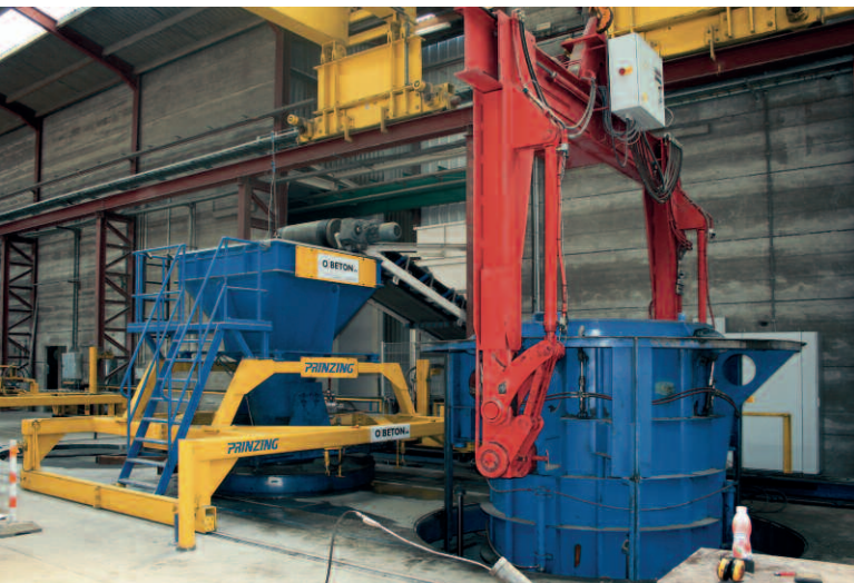
Во время съема формы происходит заполнение бункера бетонораздатчика
