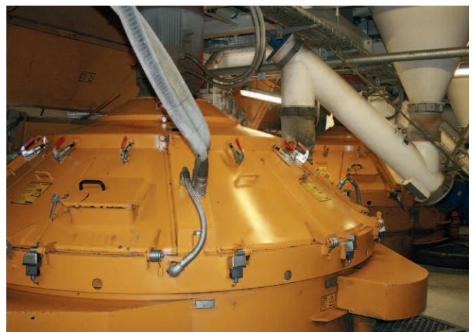
В смесительной башне было смонтировано два идентичных смесителя Naapur (3750 л)
