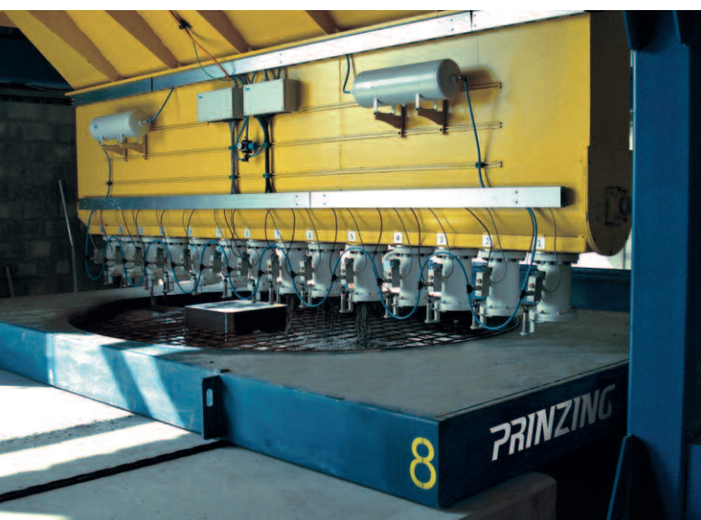
Полностью автоматическая литьевая установка Zelus заполняет форму самоуплотняющимся бетоном при помощи клапанов с индивидуальным управлением
