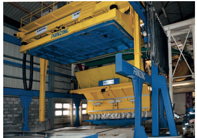
Установка Zelus фирмы Prinzing с системой подачи бетона и краном-роботом
