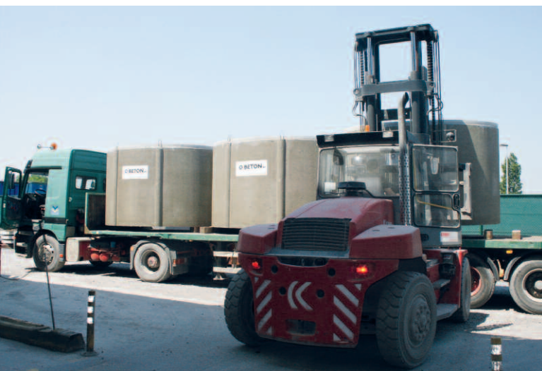
Готовые бетонные контейнеры загружаются на грузовики для отправки на стройплощадку
