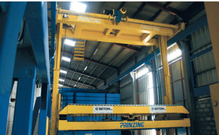
Кран-робот обслуживает склад форм литьевой установки Zelus в полностью автоматическом режиме
