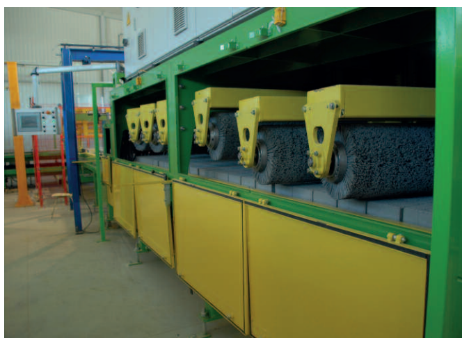
Машина для обработки поверхности с шестью щеточными валиками
