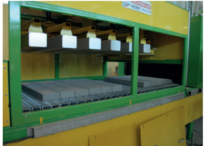
Инфракрасный тоннель с шестью излучателями
