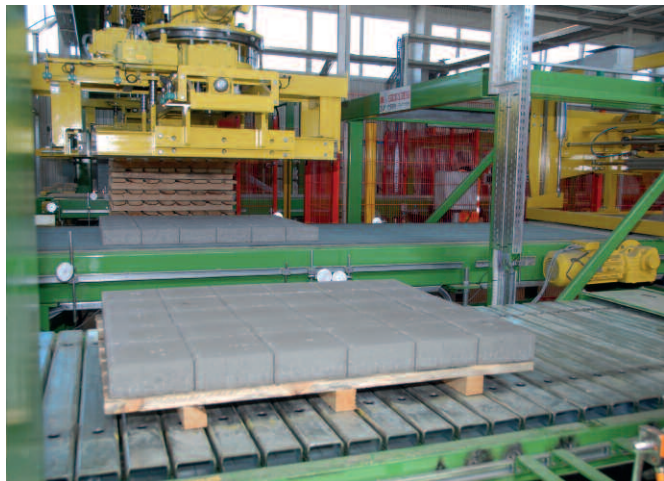
Четырехсторонний захват для подачи слоев камней на линию по облагораживанию, на заднем плане виден склад поддонов
