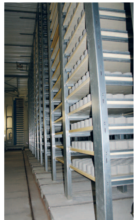
Стеллажи для выдержки изделий фирмы Roitho вмещают до 6776 поддонов
