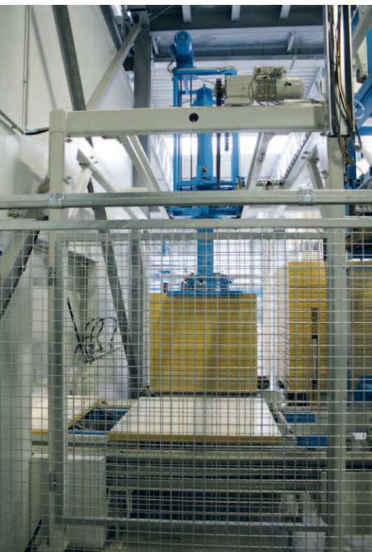
Раскладчик помещает поддоны по отдельности на конвейер, подающий их на камнеформовочную машину
