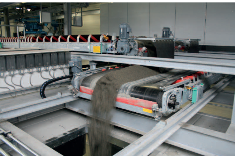
Ленточные транспортеры фирмы VHV Anlagenbau доставляют бетон из смесителей на камнеформовочную машину
