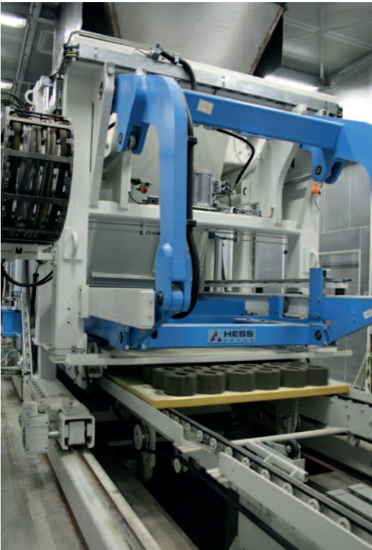
Клиновой ременной транспортер доставляет поддоны со свежесформованными изделиями в камеры тепловлажностной обработки
