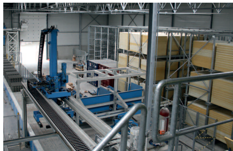
Пакетиловщик Servo 700 фирмы Hess на сухой стороне, стеллаж для форм и склад для промежуточного хранения поддонов
