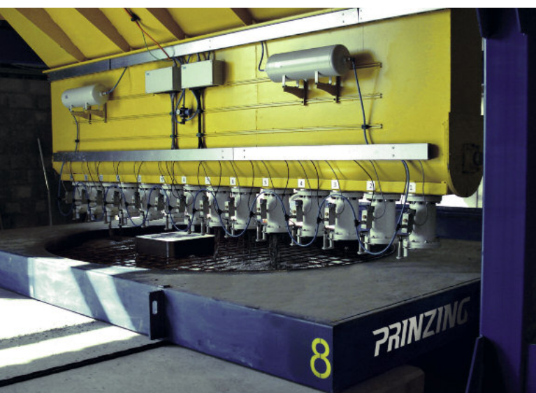
W pełni zautomatyzowana maszyna Zelus napełnia formę samozagęszczalną mieszanką betonową poprzez pojedynczo zatłaczane zawory zaciskowe.
