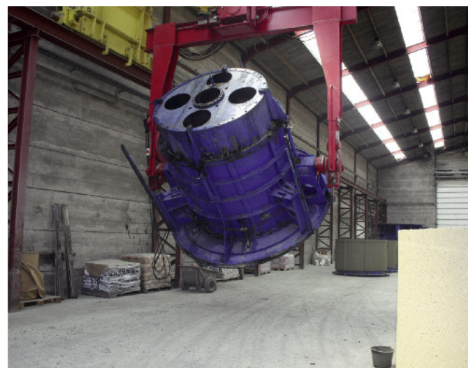
Podczas transportowania do obszaru rozformowywania forma jest odwracana hydraulicznie.
