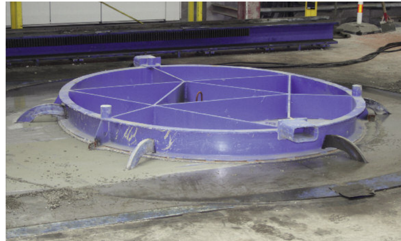
Poprzez dociśnięcie podkładu i ponowne wibrowanie zbiornik jest całkowicie szczelny.
