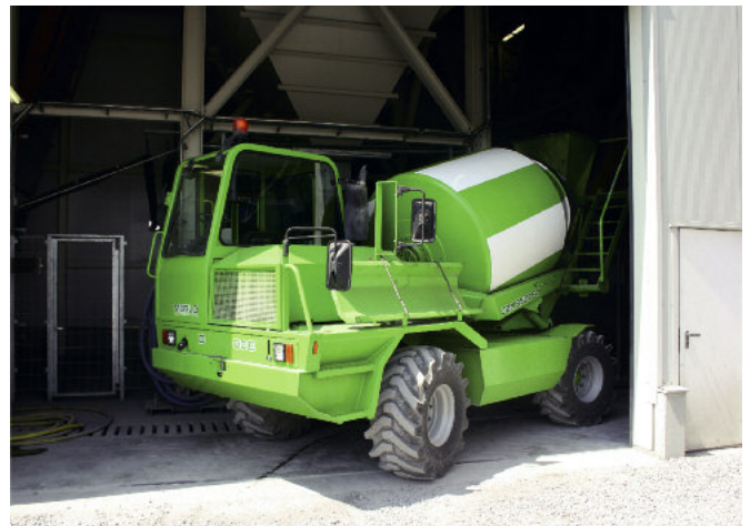
Betonowóz firmy Merlo.
