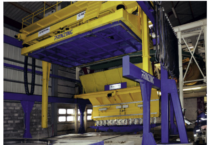
Maszyna Zelus firmy Prinzing wraz z podajnikiem mieszanki betonowej i robotem suwnicowym.
