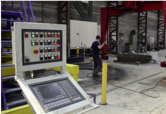
Panel sterowania, z którego obsługuje się całą linię.
