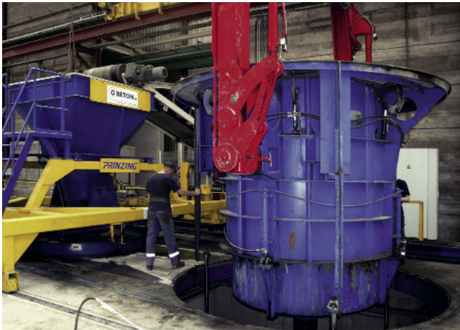
Po wyjęciu zbiornika forma jest ponownie ustawiana na stanowisku produkcyjnym i rozpoczyna się kolejny cykl produkcyjny.
