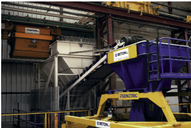
Mieszanka betonowa o konsystencji wilgotnej jest dostarczana do maszyny Atlas za pośrednictwem zasobników poruszających się po estakadzie i zasobnika pośredniego.
