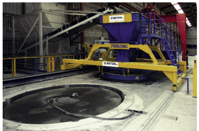
Na stanowisku produkcyjnym nr 1 odbywa się produkcja, pośrodku napełniany jest zasobnik mieszanki betonowej, a stanowisko nr 2 jest przygotowywane do produkcji kolejnego zbiornika.
