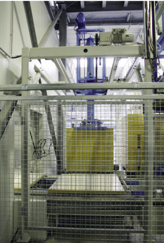
Podajnik podkładów produkcyjnych umieszcza podkłady pojedynczo na stanowisku wejściowym wibroprasy.
