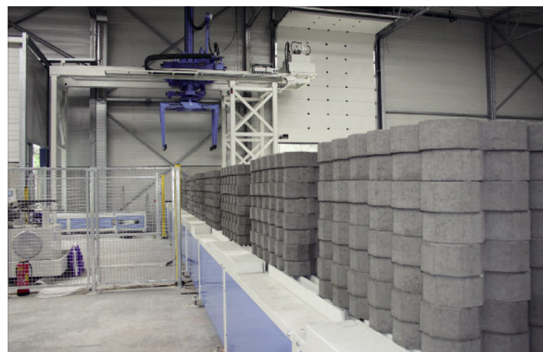
Przenośnik skokowy transportuje paczki wyrobów do manipulatora.
