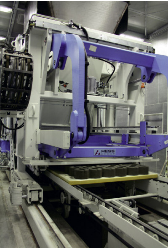
Przeñośnik pasowy transportuje podkłady ze świeżymi elementami betonowymi do komory dojrzewania.
