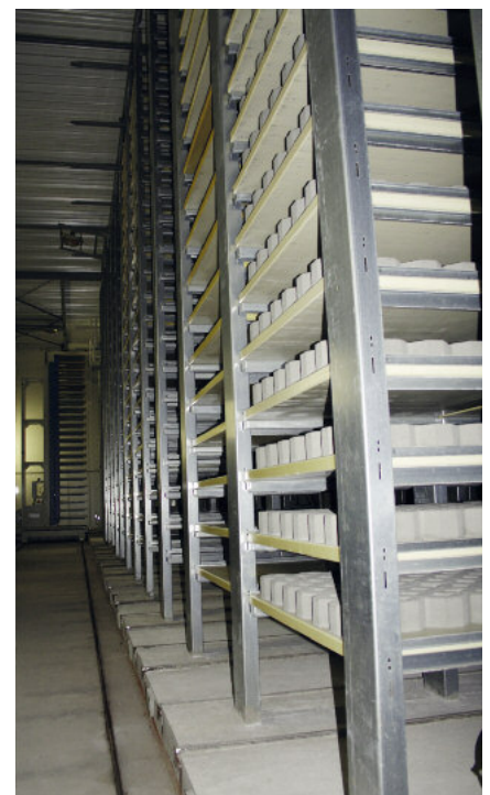
Regał dojrzewania firmy Rotho o pojemności 6 776 podkładów.
