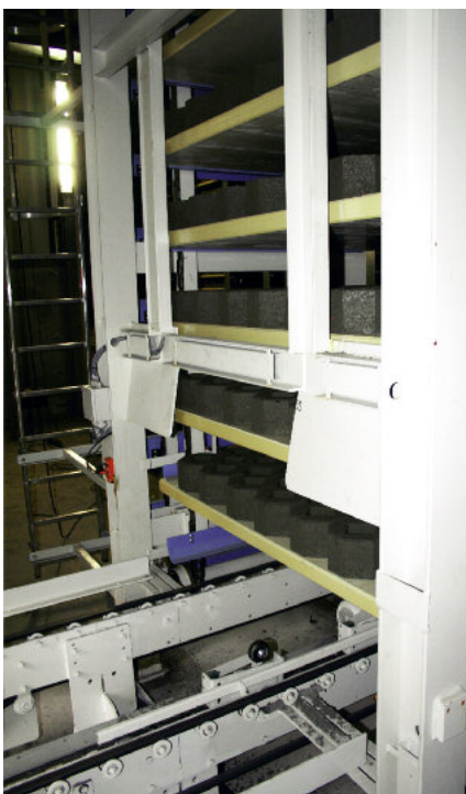
Winda piętrująca może pomieścić do 22 podkładów.
