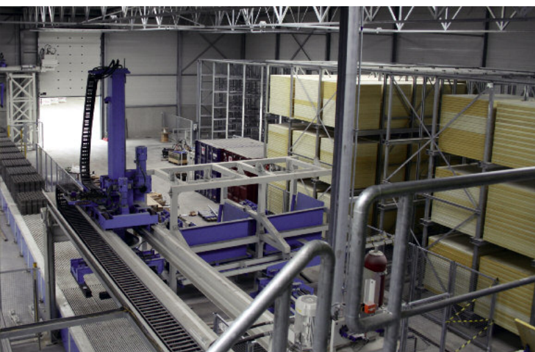
Urządzenie pakietujące Servo 700 firmy Hess na linii suchej, regał z formami i bufor podkładów produkcyjnych.
