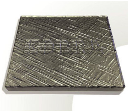
Wzorec stempla do testów produkcji prototypów elementów betonowych.
