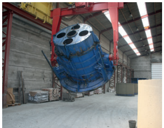
Durante la rimozione per il disarmo si volta idraulicamente lo stampo.
