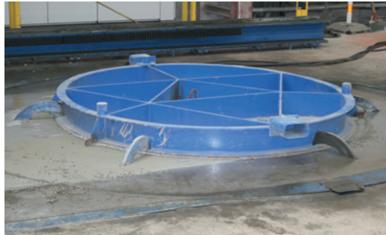
Mediante la pressione del pallet e ripetendo la vibrazione, il serbatoio diventa assolutamente a tenuta.
