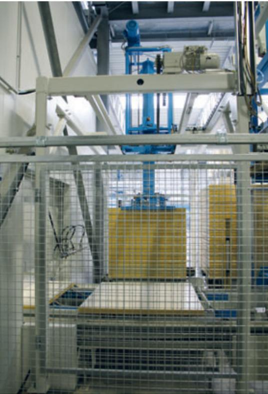
*Il traslatore deposita le piastre di appoggio di un pacchetto singolarmente sull'alimentatore tavole della blocchiera*
