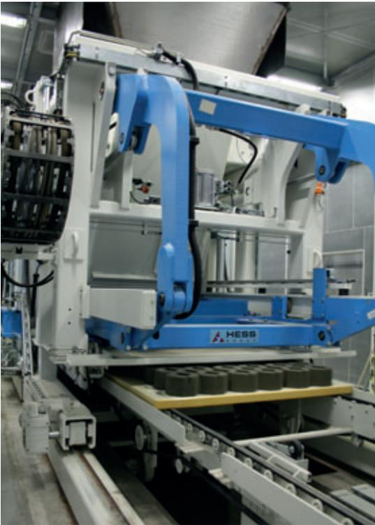
Il trasportatore a cinghia trapezoidale consente di trasportare le piastre di appoggio con i prodotti freschi alla camera di maturazione.
