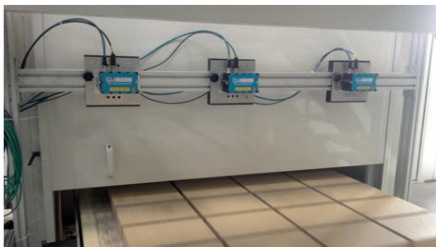
Il sistema di misurazione dell'altezza dei blocchi SHV 500 di R&W Industrieautomation supervisiona la precisione di altezza dei prodotti freschi.
