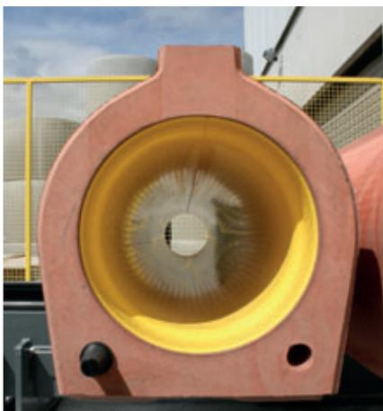
L'innovativa tubazione di scarico delle acque fognarie Perfect Pipe combina i vantaggi del materiale sintetico antiabrasivo con quelli della resistenza alle sollecitazioni di carico e di resistenza alla flessione del calcestruzzo.
