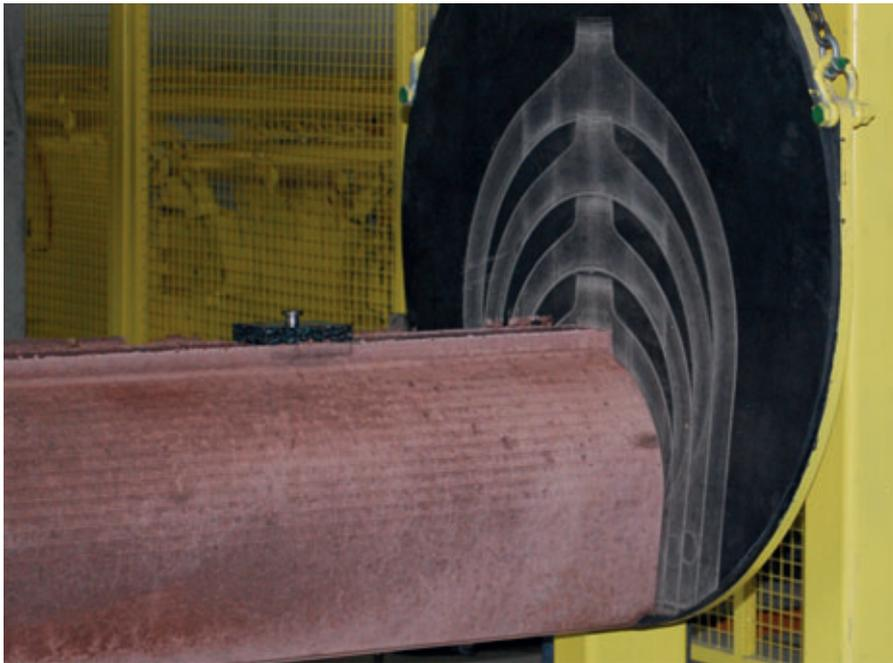
*I tubi in calcestruzzo leggermente compresso induriti in casseforme vengono prodotti in ciclo completamente automatico, con test finale di tenuta stagna.*
