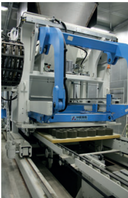
Le convoyeur à courroies trapézoïdales transporte les planches de support garnies de produits frais vers la chambre de durcissement.
