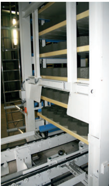
L'ascenseur prend en charge jusqu'à 22 planches de support
