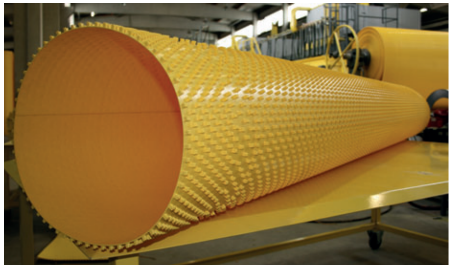
Le liner en PEHD, roulé en cylindre au début du processus de production, présente un grand nombre de points d'ancrage sur sa surface extérieure – pour un ancrage solide dans le béton.
