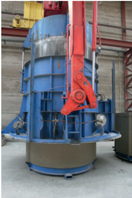
Le processus de décoffrage est entièrement piloté par une poire de commande.
