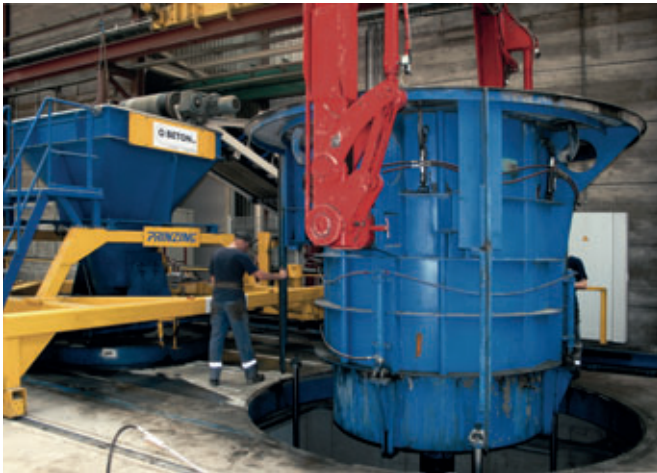
Après le décoffrage, le moule est remis en place dans la station de travail et le produit suivant peut être fabriqué.
