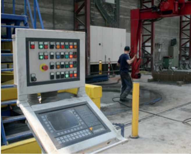
L'appareil de commande avec menu de navigation, c'est d'ici que tout est piloté.
