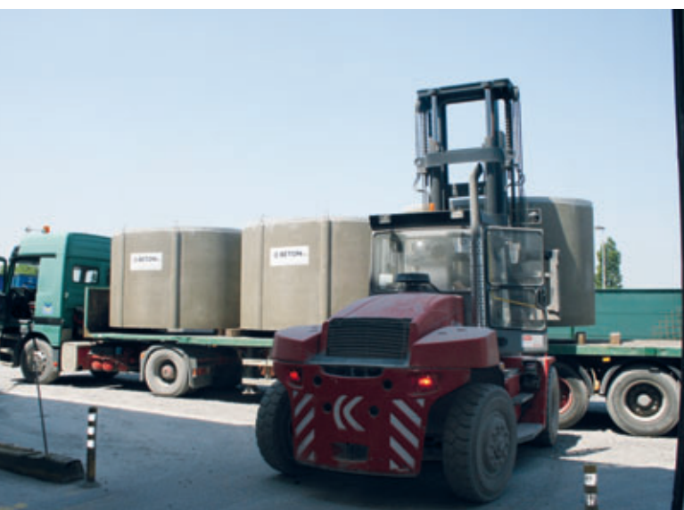
Les citernes en béton finies sont chargées sur camion pour leur transport sur chantier.
