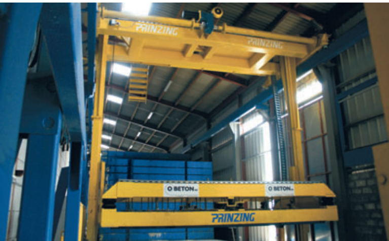
Un robot-grue gère et dessert automatiquement le stock de moules de l'installation de coulage Zelus.
