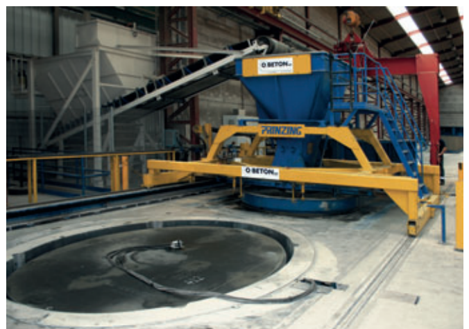
La production est en cours sur la station 1, le silo de béton est rempli en position centrale et la station de production 2 est préparée pour le produit suivant.
