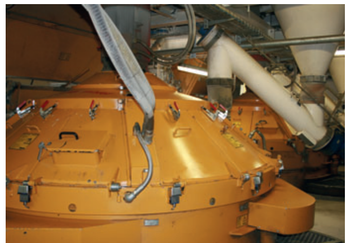
La tour de malaxage abrite deux malaxeurs identiques de Haarpur (3.750 l).
