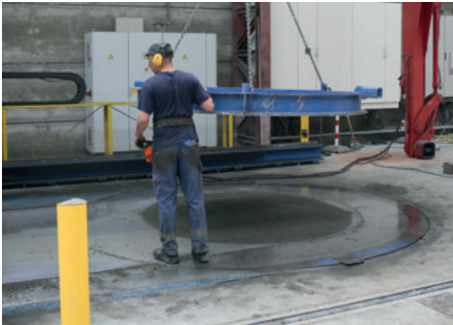
La palette est automatiquement serrée sur le moule rempli et compacté.
