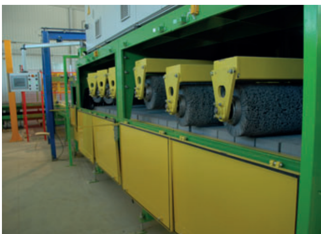
Machine de glaçage avec six rouleaux à brosses
