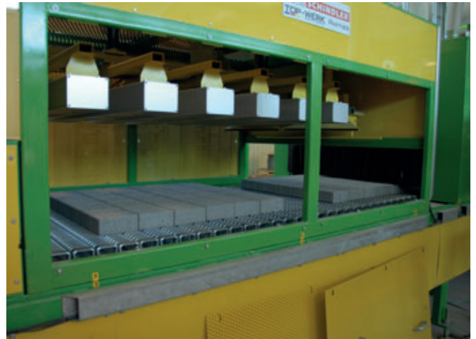
Tunnel infrarouge de chauffe avec six radiateurs
