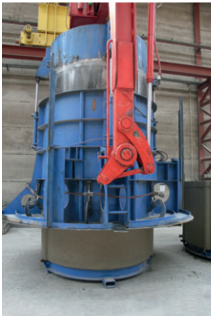
El proceso de desencofrado completo es controlado con la botonera de mando.
