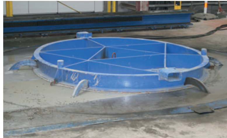
Gracias a la colocación a presión de la placa y de la vibración adicional simultánea, el depósito queda perfectamente estanco.
