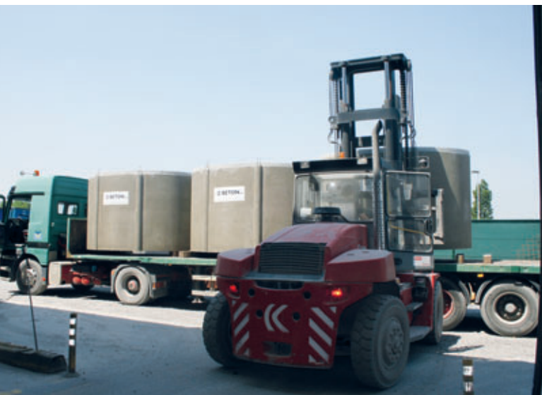
Los depósitos de hormigón terminados son cargados en los camiones para su transporte a obra.
