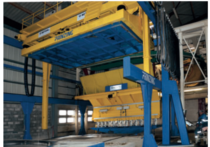
Instalación Zelus de Prinzing con alimentación de hormigón y robot grúa
