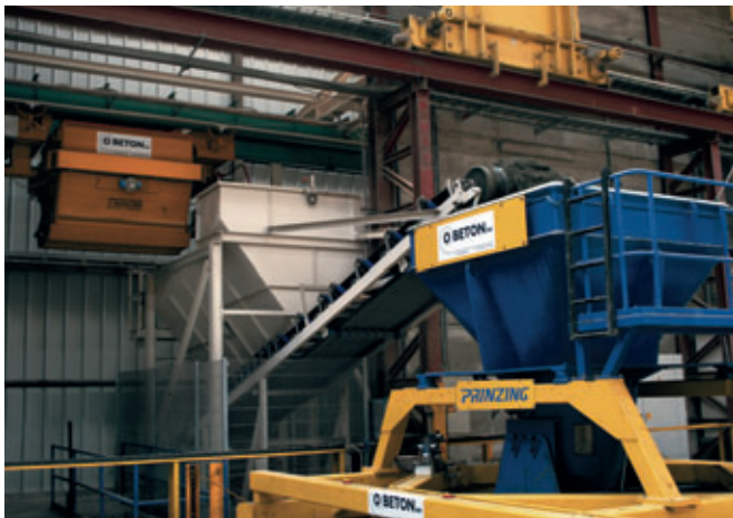
A través de una cuba aérea y un silo previo se alimenta el Atlas con hormigón ligeramente húmedo
