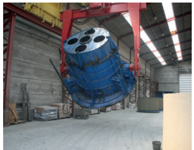
Durante el transporte hacia el desencofrado, el molde es girado hidráulicamente.
