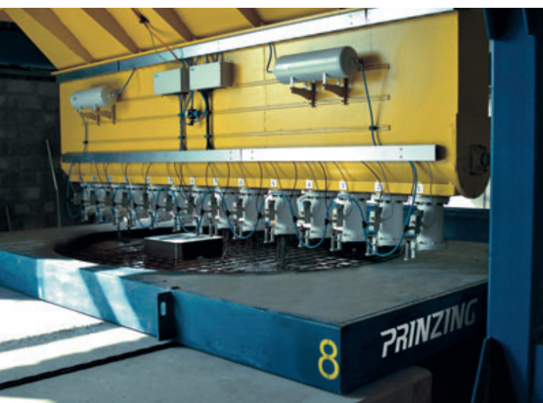
La instalación de colada completamente automática Zelus llena el molde con hormigón autocompactante a través de válvulas de manguito controladas individualmente
