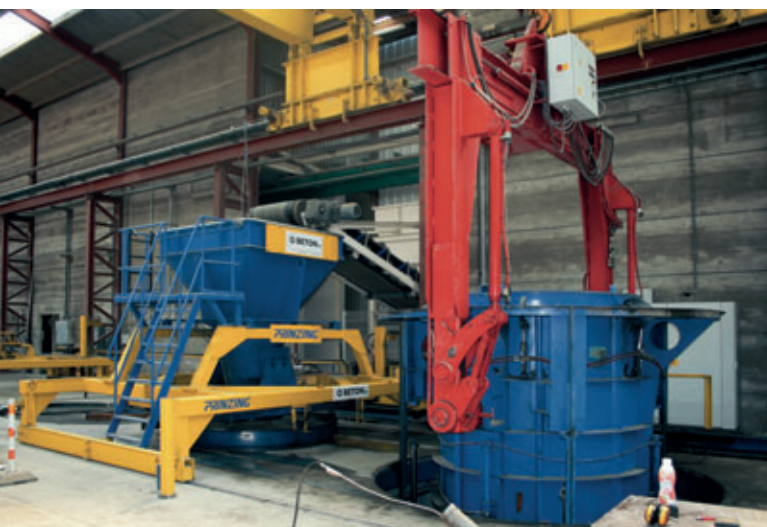
Durante la retirada del molde se vuelve a llenar el silo de material en la posición central.
