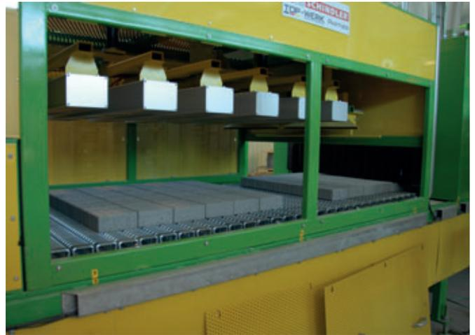
Túnel de calentamiento infrarrojo con seis radiadores
