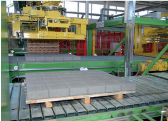
Pinza de cuatro lados para la introducción de las capas de adoquines al acabado; en el fondo puede apreciarse el depósito intermedio de palés
