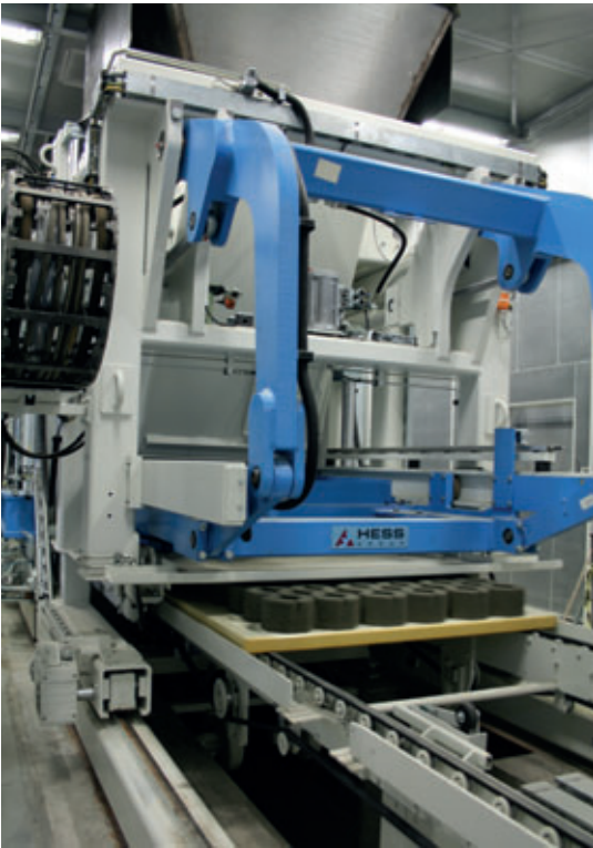
Las bandejas con los productos frescos son transportadas con el transportador de correa trapezoidal a la cámara de fraguado.
