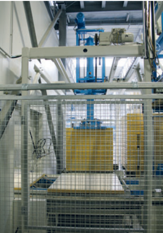
El manipulador coloca las bandejas de un paquete individualmente sobre la entrada de bandejas de la máquina de producción de bloques
