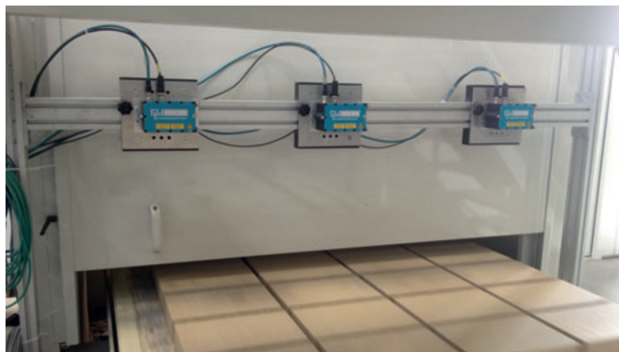
El sistema de medición de altura de bloque SHV 500 de R&W Industrieautomation supervisa la exactitud de altura de los productos frescos.
