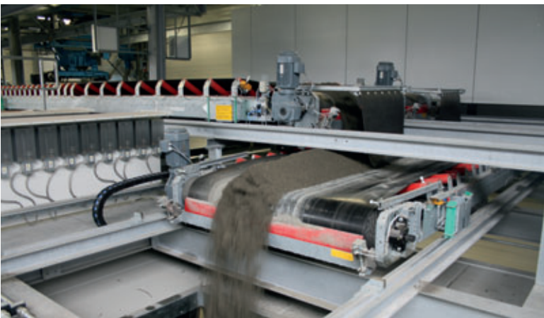
Las cintas transportadoras de VHV Anlagenbau transportan el hormigón de las mezcladoras hasta la máquina de producción de bloques
