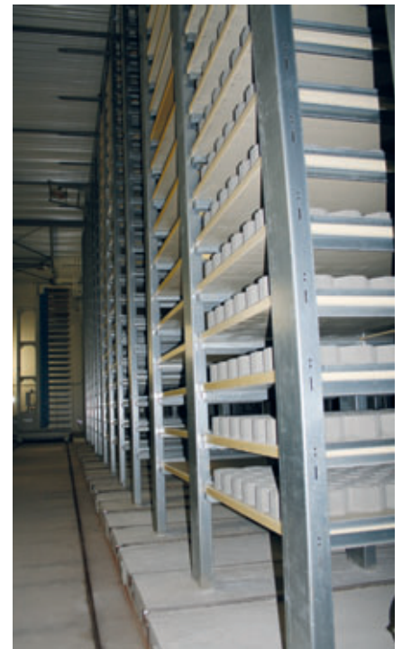
La estantería de fraguado de Rotho ofrece espacio para hasta 6776 bandejas
