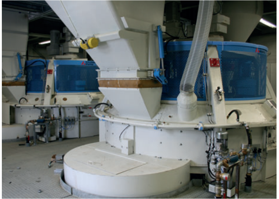
Las dos mezcladoras forzadas SM 3000-2 de Schlosser Pfeiffer
