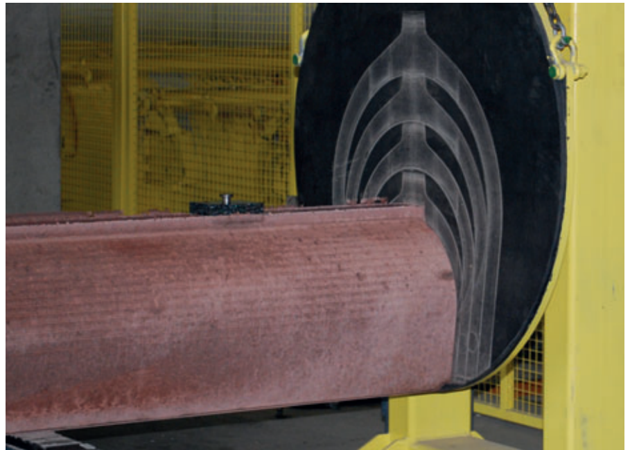
Los tubos de hormigón ligeramente armado y de revestimiento sólido, después de un proceso de producción completamente automático, se someten a un control de estanqueidad.
