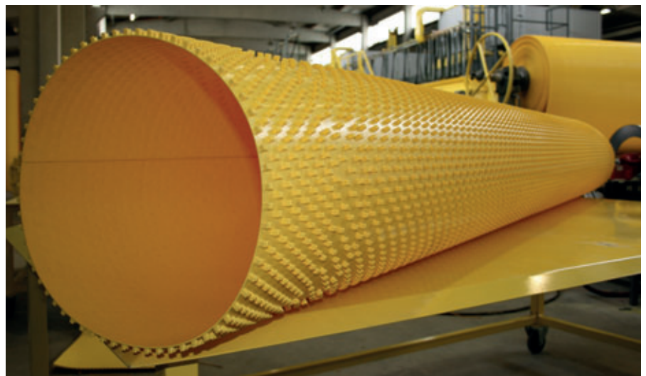
El liner HDPE, transformado en cilindros durante la producción de tubos, cuenta con numerosos anclajes en la parte exterior, para asegurar un anclaje firme al hormigón.
