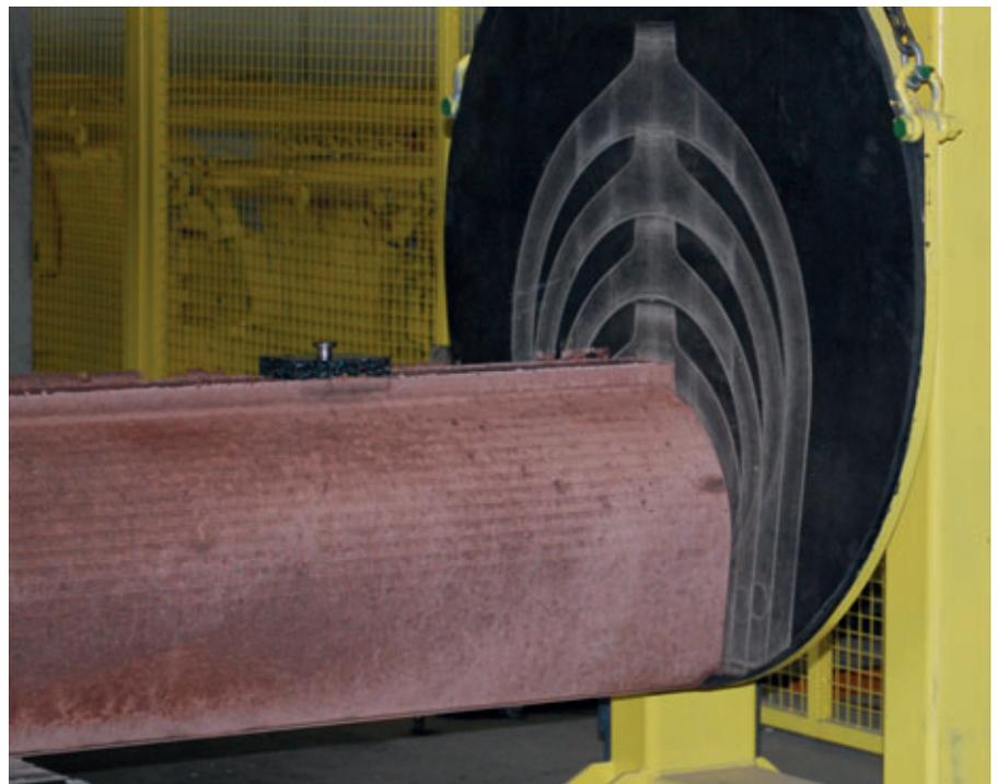
Die schalungserhärteten Rohre aus leichtverdichtendem Beton werden in einer vollautomatischen Fertigung abschließend einer Dichtheitsprüfung unterzogen.
