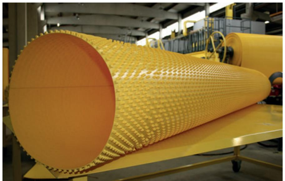
Der in der Rohrfertigung zu Zylindern verarbeitete HDPE-Liner zeigt eine Vielzahl an Ankern auf der Außenseite – für die feste Verankerung im Beton.
