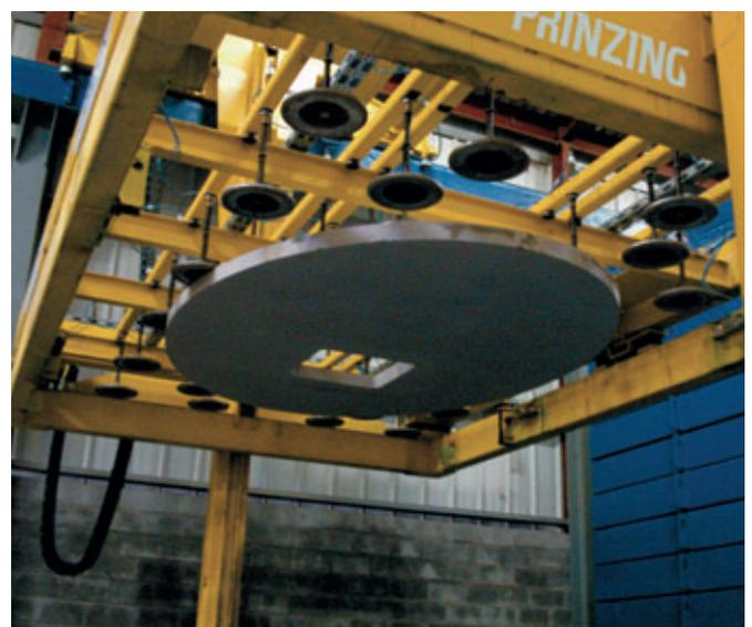
Mit Vakuum-Greiftechnik werden die abgebundenen Behälterdeckel aus der Form entnommen.
