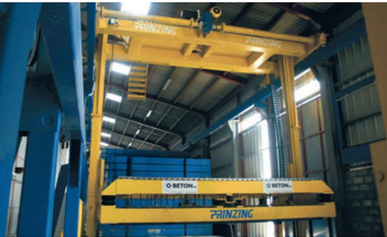
Ein Kranroboter verwaltet und bedient das Formenlager der Zeluss-Gießanlage vollautomatisch.
