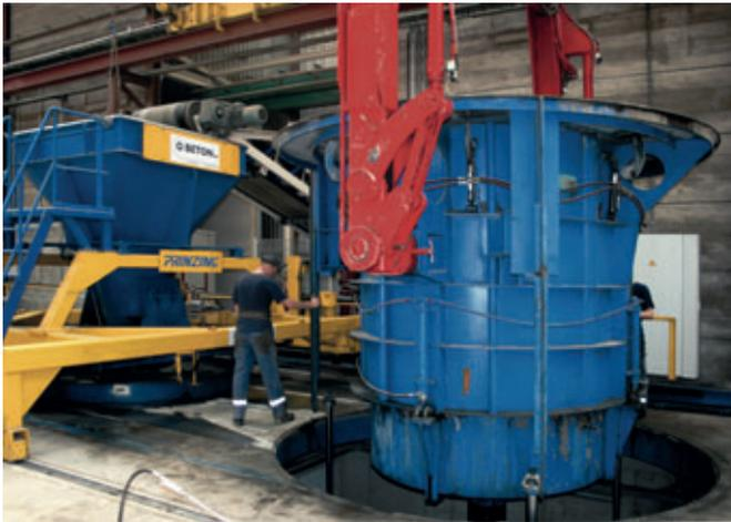
Nach dem Entschalen wird die Form wieder in die Arbeitsstation gesetzt und das nächste Produkt kann hergestellt werden.
