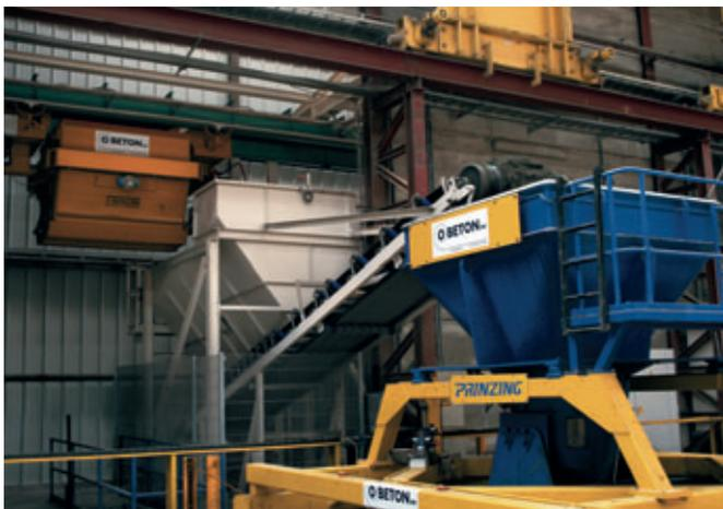
Über eine Kübelbahn und ein Vorsilo wird die Atlas mit erdfeuchtem Beton versorgt.
