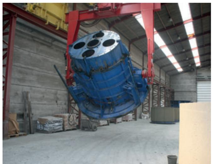
Beim Abtransport zum Entschalen wird die Form hydraulisch gewendet.
