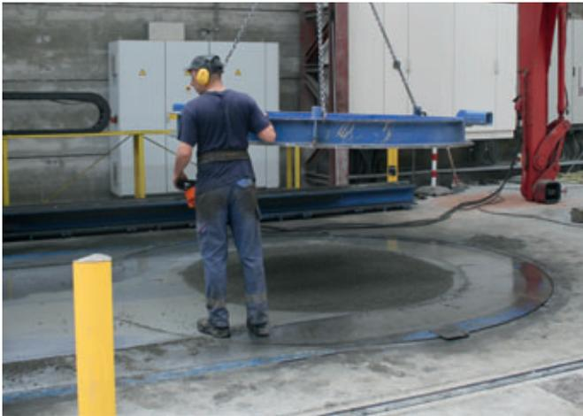
Auf der gefüllten und verdichteten Form wird die Palette automatisch verspannt.
