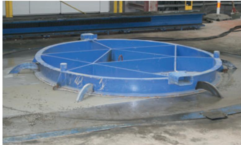
Durch das Einpressen der Palette und dem dabei nochmaligen Rütteln wird der Behälter absolut dicht.
