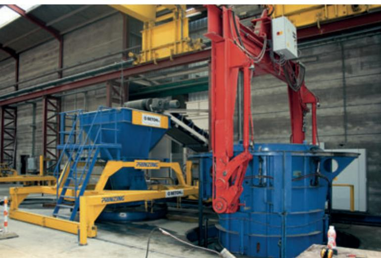
Während des Abtransportes der Form wird das Materialsilo auf der Mittelposition neu befüllt.
