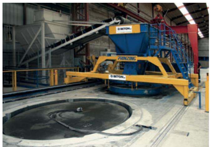
Auf der Fertigungsstation 1 wird produziert, das Betonsilo wird in der Mittelposition befüllt und die Fertigungsstation 2 wird für das nächste Produkt vorbereitet.
