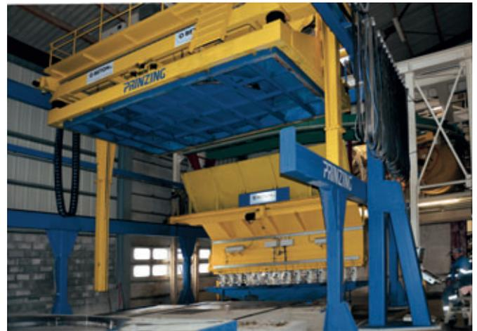
Zelus-Anlage von Prinzing mit Betonbeschickung und Kranroboter
