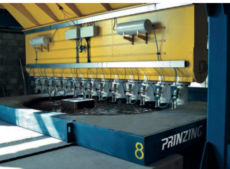
Die vollautomatisch arbeitende Gießanlage Zelus befüllt durch einzeln angesteuerte Quetschventile die Form mit selbstverdichtendem Beton.
