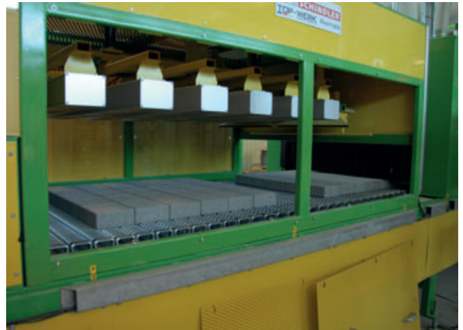
Infrarotheiztunnel mit sechs Strahlern
