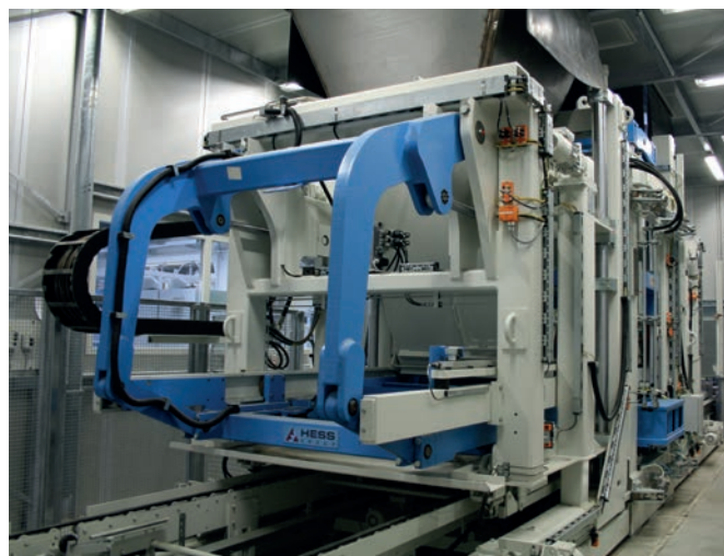
Hess 公司制造的 Multimat 混凝土砌块成型机，该机器所有承受压力的组件都经过特殊的坚固设计
