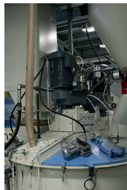
Kniele 公司的饰面混凝土搅拌机
