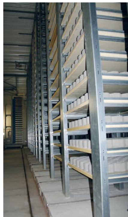
Rotho 公司提供的固化机架系统最多可容纳 6,776 块栈板
