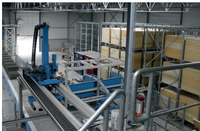
Hess 公司的 Servo 700 封包装配机放置在干边，模具架，以及板材缓存架
