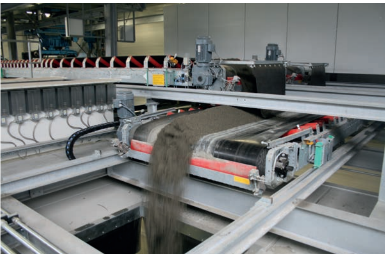
VHV Anlagenbau 公司的传送带输送机将混凝土从搅拌机传输到混凝土砌块成型机上
