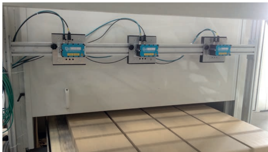
R&W 工业自动化有限公司的SHV500型砌块高度测量系统以高精度水平监控新拌产品
