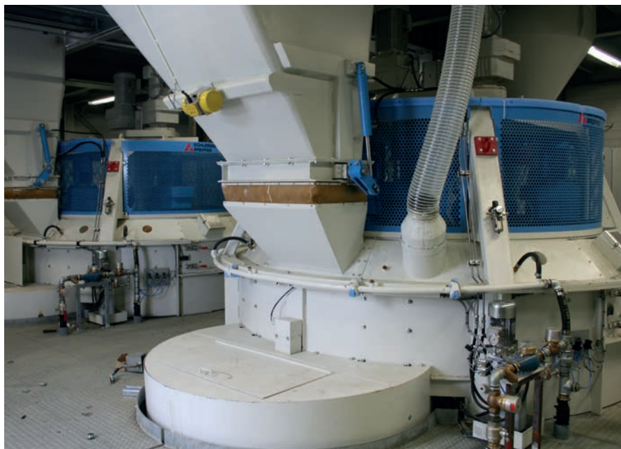
Schlosser Pfeiffer 公司的两台 SM 3000-2 型行星式搅拌机
