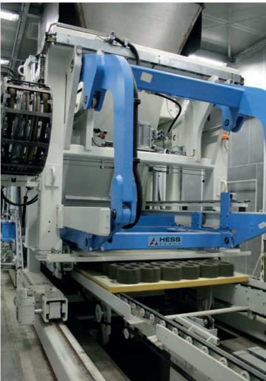
放置新拌产品的栈板被运至固化室的V型传送带输送机上
