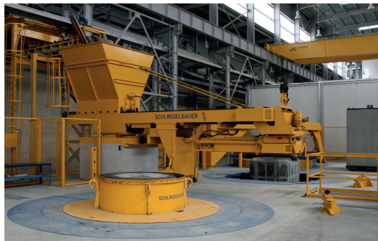
Гибкая производственная установка Exact XL готова для следующего такта производства труб
