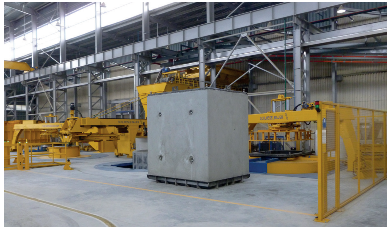
Благодаря использованию стальных верхних муфт, установка типа Exact XL обеспечивает точность соединения всех изделий – как труб, так и прямоугольных профилей
