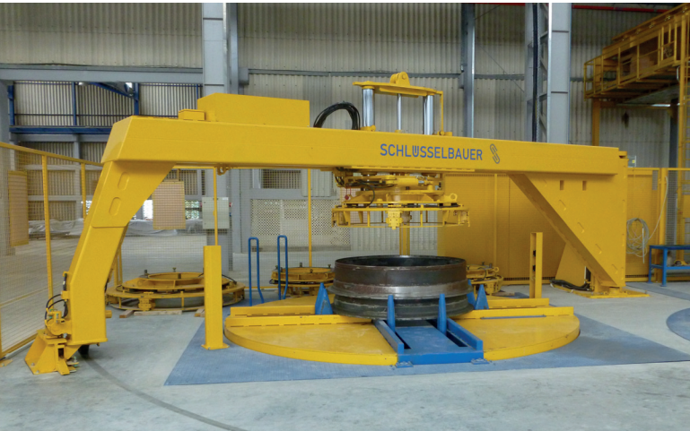
Перед началом прессования верхние муфты автоматически подаются на установку и остаются на изделии в течение всего цикла твердения
