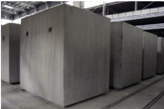
Wielkoformatowe ramowe elementy o wymiarach 2000x1500, 2000x2000, 2000x2500 oraz 2500x2500 mm są produkowane na skalę przemysłową przez Amiantit Oman Concrete Products LLC.
