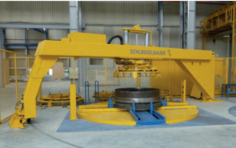
Die Obermuffen werden automatisch vor dem Pressvorgang in die Maschine eingefahren und bleiben für den gesamten Aushärtezyklus am Produkt.
