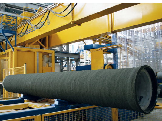
Преднапряженные железобетонные напорные трубы со стальным цилиндром внутри абсолютно герметичны и идеально подходят для рабочего давления до 25 Бар
