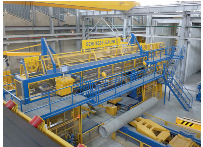
Последние инновации Schlüsselbauer повышают скорость и точность предварительного напряжения проволоки для напорных труб
