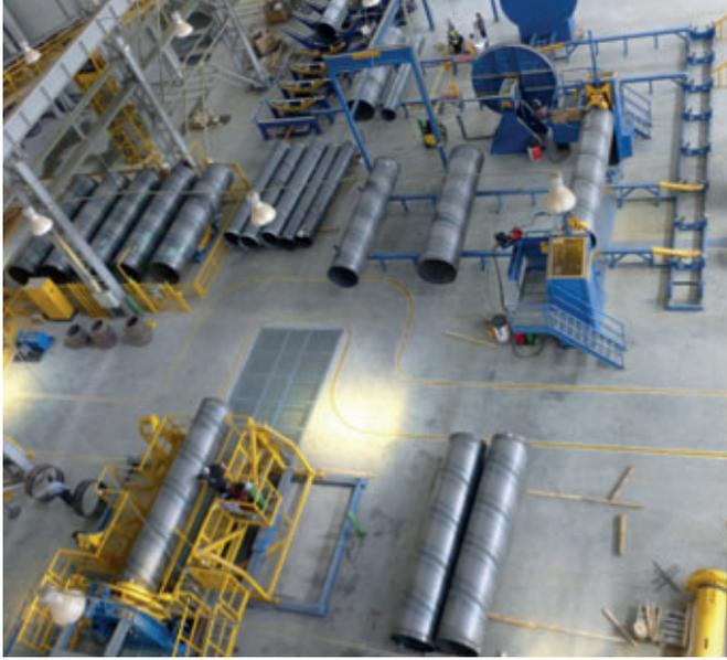
La fabrication des cylindres en acier est strictement contrôlée et constitue un point central de la fabrication des tuyaux pression en béton.
