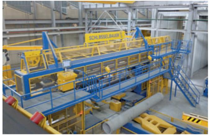
Grâce aux dernières innovations de Schlüsselbauer, la vitesse et la précision de la précontrainte des fils métalliques pour la fabrication des tuyaux pression ont pu être améliorées.
