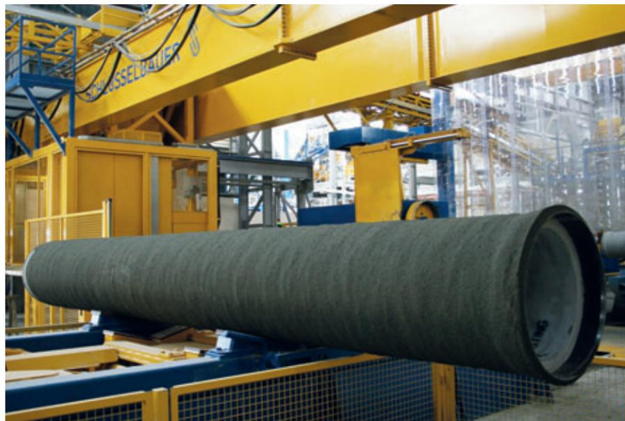
*Ces tuyaux pression précontraints en béton, avec cylindre en acier intérieur, sont parfaitement étanches et résistent à une pression jusqu'à 25 bar.*
