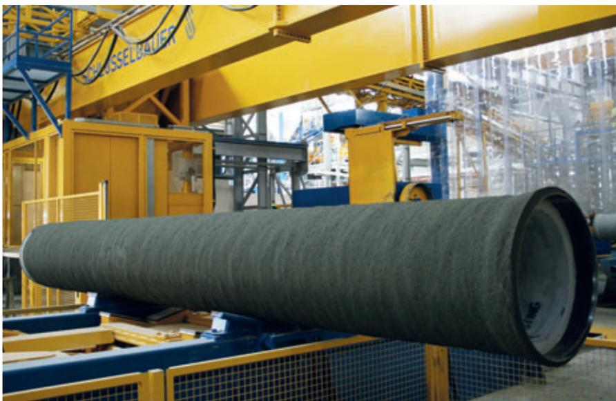
Los tubos de presión de hormigón con pre-tensión y cilindro de acero interior son absolutamente estancos y resultan ideales para su utilización con presiones de trabajo de hasta 25 bares.
