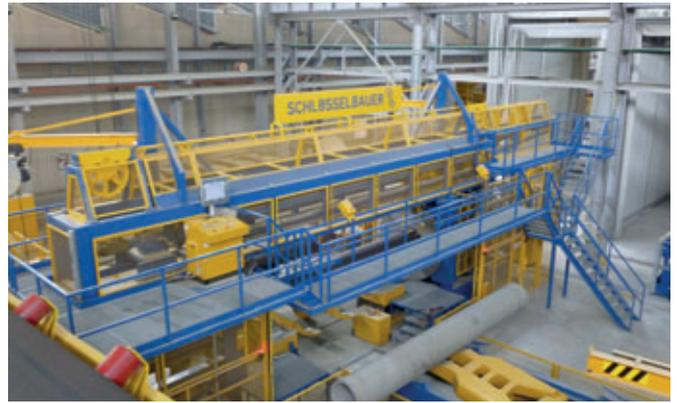
Con los avances más recientes de Schlüsselbauer, se ha aumentado la velocidad y precisión del pre-tensionado del cable para la fabricación de tubos de presión.
