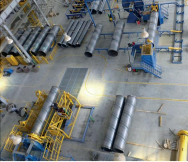
La fabricación de cilindros de acero en condiciones controladas representa un elemento central de una producción de tubos de presión de hormigón.
