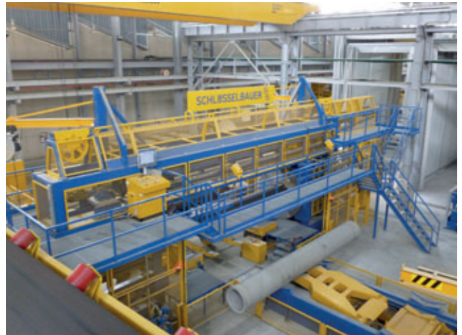
Gesteigert wurden durch aktuelle Neuentwicklungen von Schlüsselbauer die Geschwindigkeit und Präzision der Drahtvorspannung für die Druckrohrfertigung.
