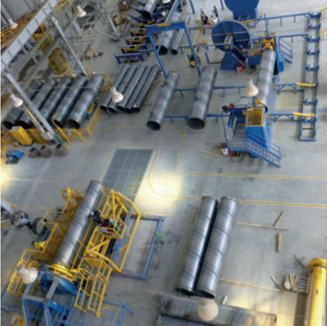
Die Herstellung von Stahlzylindern unter kontrollierten Bedingungen stellt ein zentrales Element einer Betondruckrohrfertigung dar.
