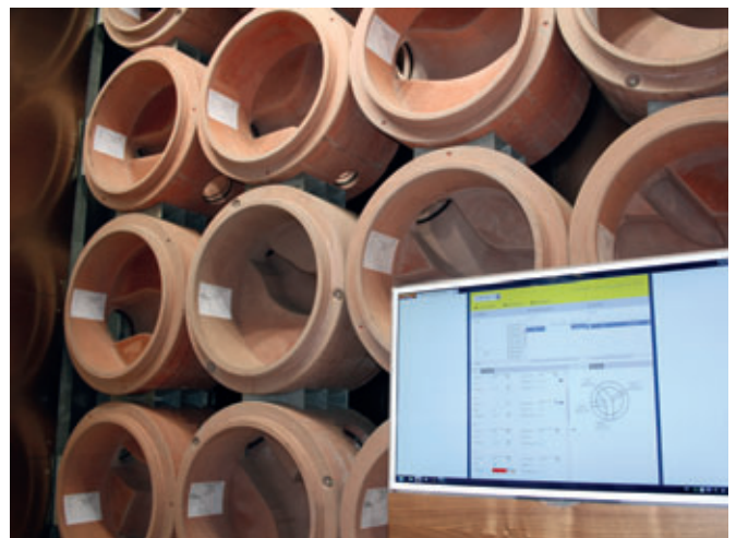
Mittlerweile ein Synonym für hochqualitative, maßgefertigte, schalungserhärtete Betonschachtunterteile – Perfect.
