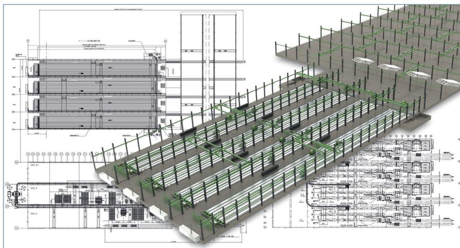
Завод ЖБИ в Башмах состоит из трех зданий. В одном будут производиться пустотные панели (линия экструдирования), в другой - элементы фасадов (циркуляционные линии) и в третьем - прочие сборные элементы в кассетной опалубке. Все оборудование поставлено компанией **Elematic**
