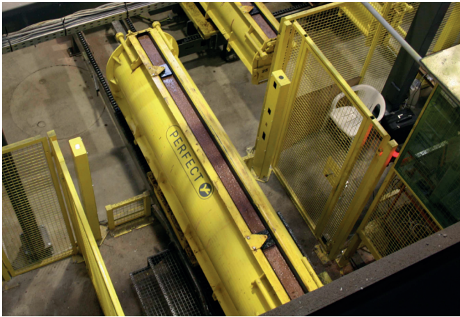
Заполненная форма покидает участок заливки
