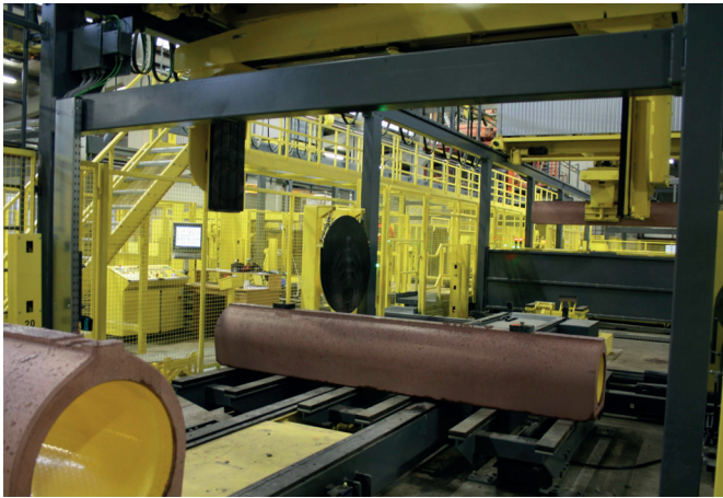
Все трубы проверяются на герметичность прежде, чем они покидают участок, где с них снимается опалубка
