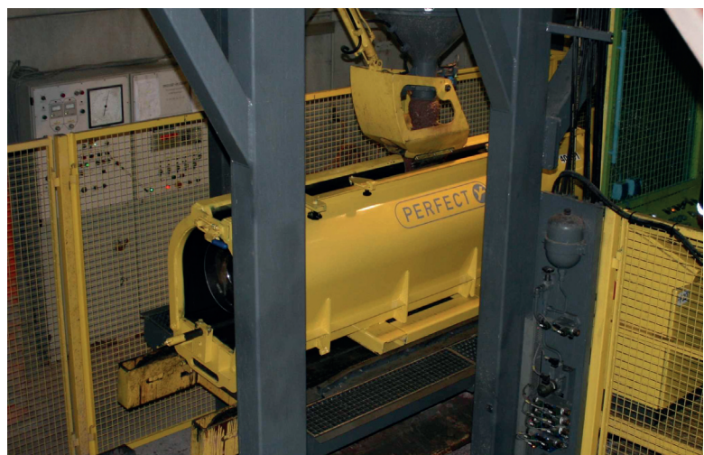
В процессе заливки бетона форма помещается подвижный стол
