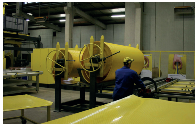
Раскрой полиэтиленовой пленки с рулона для изготовления инлайнеров
