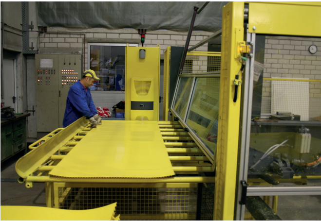
Точно отрезанная полиэтиленовая пленка загружается в сварочную установку
