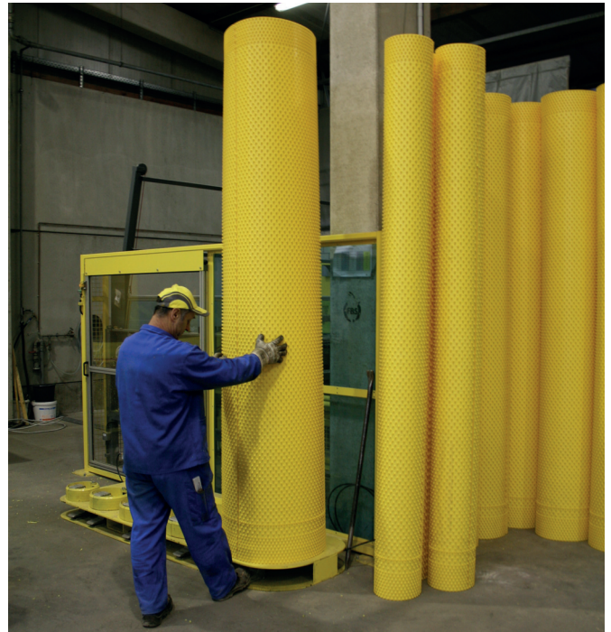
По завершении процесса сварки сварочный шов проверяется на прочность на разрыв
