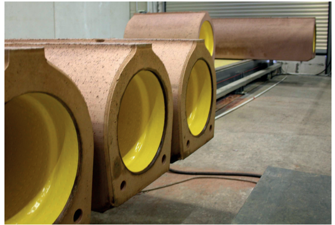
Готовая труба с плоской подошвой при перемещении на внешний склад
