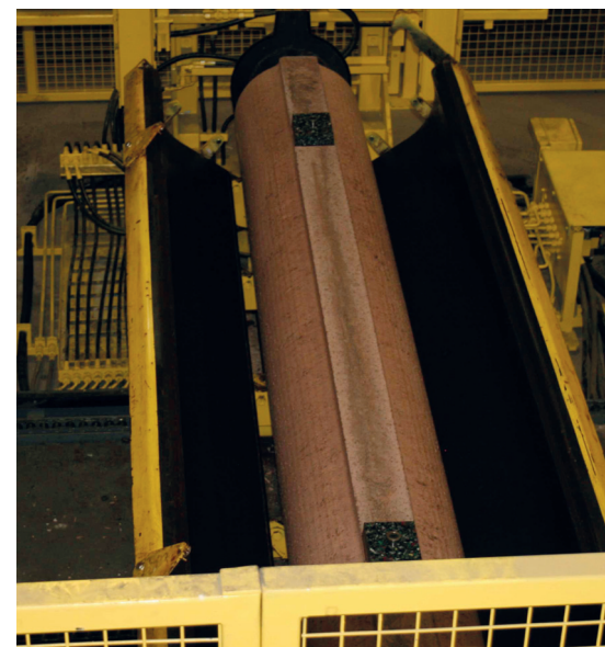
Процесс снятия опалубки с трубы Perfect Pipes
