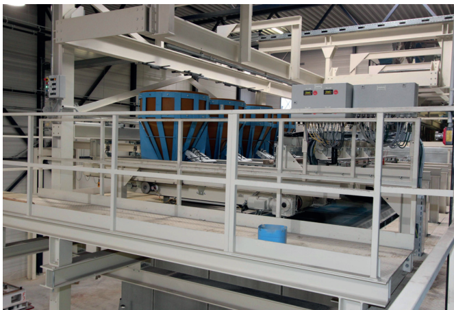
Заполнение силоса системы Colour Mix осуществляется при помощи четырех небольших индивидуальных ковшей. Благодаря высокой гибкости цветового распределения система Colour Mix компании Masa позволяет получать уникальный рисунок поверхности при очень высокой воспроизводимости результатов
