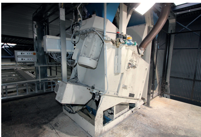
Смеситель лицевого бетона S 350/00 оборудован быстродействующим завихрителем, который, благодаря своей конструкции и высокой частоте вращения, максимально эффективно препятствует образованию комков (агломератов)
