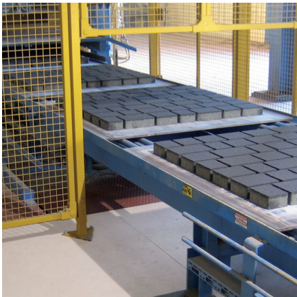
Установки для производства мелкокоразмерных бетонных элементов
