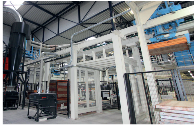
Устройство поперечного перемещения поддонов с сухой на мокрую сторону; за счет расщепления крана в любое время можно освободить проезд к установке
