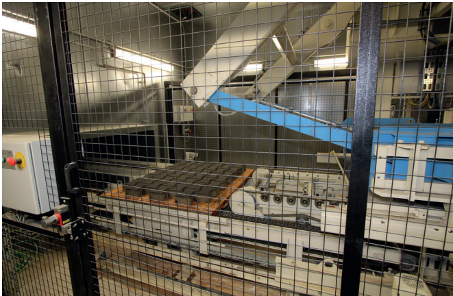
Смонтированная на заводе Redsun установка Masa XL 9.2 в быстродействующем исполнении представляет собой очень устойчивую машину с надежной станиной, оборудованную краном для смены форм и автоматической регулировкой высоты загрузочного блока для лицевого и опорного бетона
