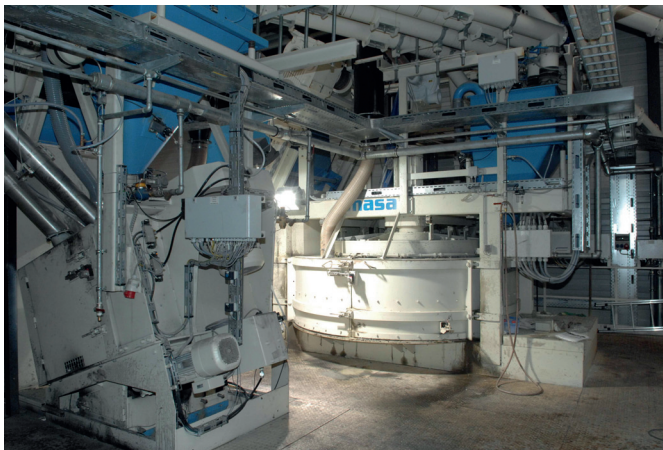
Смеситель для лицевого бетона Masa S 350/500 (слева) и горизонтальный смеситель принудительного действия Masa PH 2000/3000
