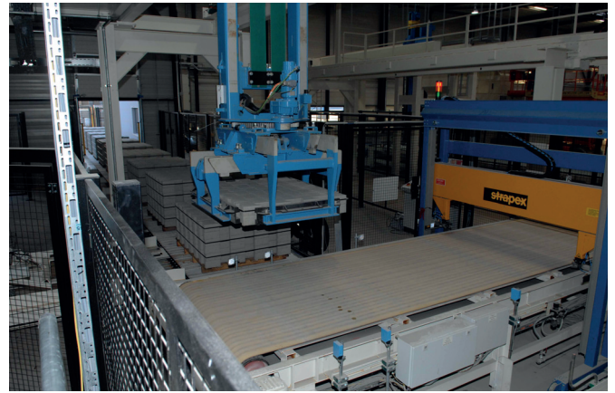
Затем слои подаются на станцию пакетирования, где штабелируются в пакеты блоков либо плит на транспортировочный паллет. На переднем плане показаны транспортер станции переформировки и обвязчик. Здесь из слоев бетонных блоков формируются новые слои любого размера в направлении транспортировки
