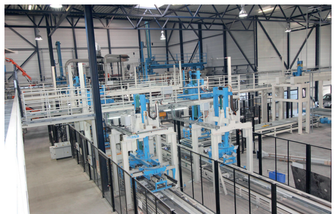
Особенностью этой концепции установки является наличие двух линий обратной транспортировки, которые могут параллельно работать с различной номенклатурой изделий
