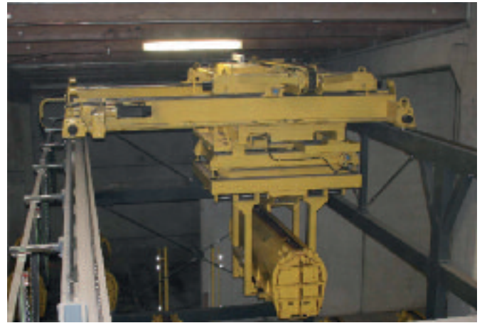
Robot suwnicowy posadawia świeżo napełnioną formę na ruchomej podłodze typu moving floor w strefie dojrzewania.
