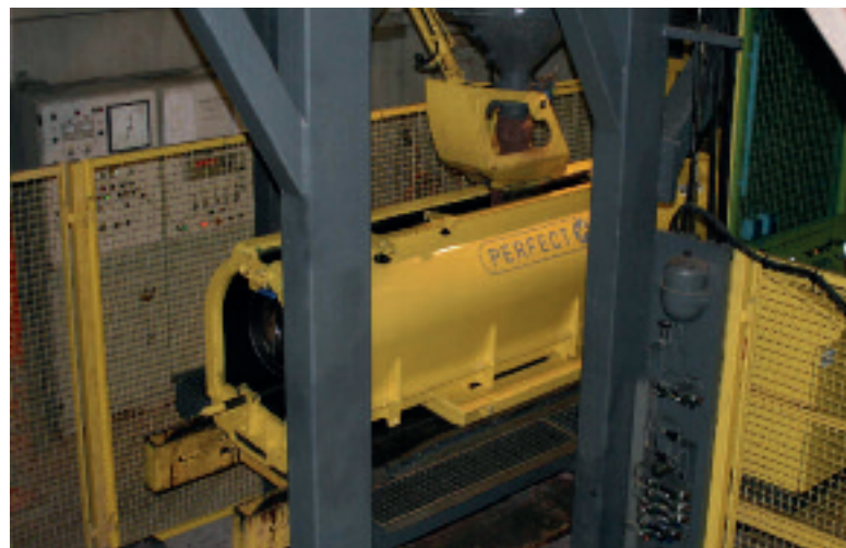
Podczas zalewania forma stoi na ruchomym stole.
