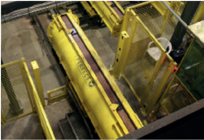
Pełne formy opuszczają stację napełniania.
