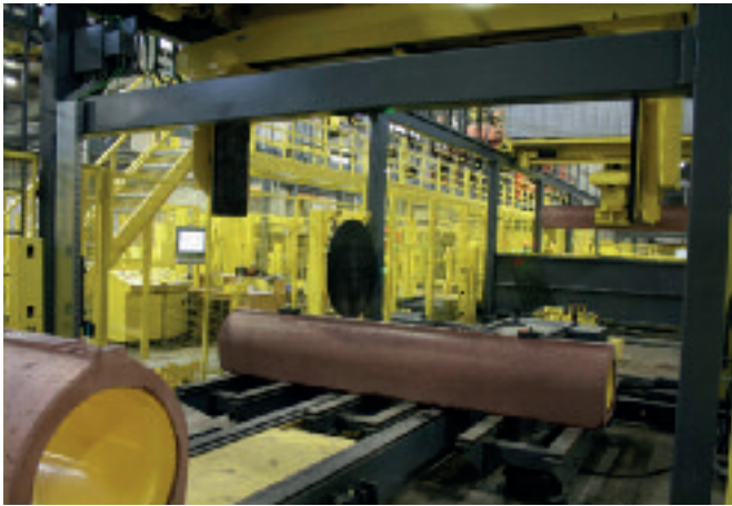
Przed opuszczeniem hali produkcyjnej sprawdzana jest szczelność każdej rury.
