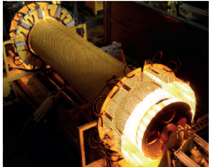
Proces termoplastycznego kształtowania kielicha.
