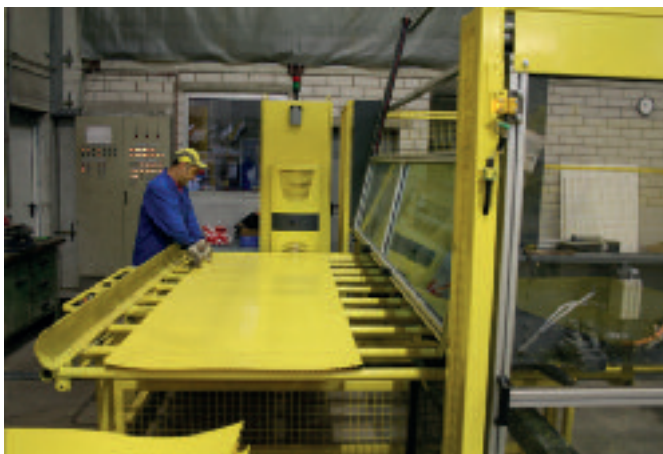
Dokładnie przycięta taśma polietylenowa wprowadzana jest do automatu zgrzewającego.
