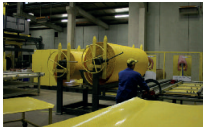
Przycinanie odpowiednich długości taśmy polietylenowej, z której wykonany zostanie inliner.
