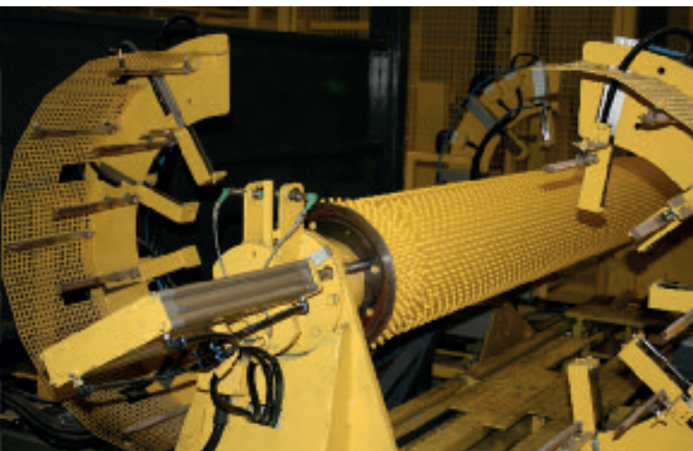
Ukształtowany kielich po zakończeniu procesu.
