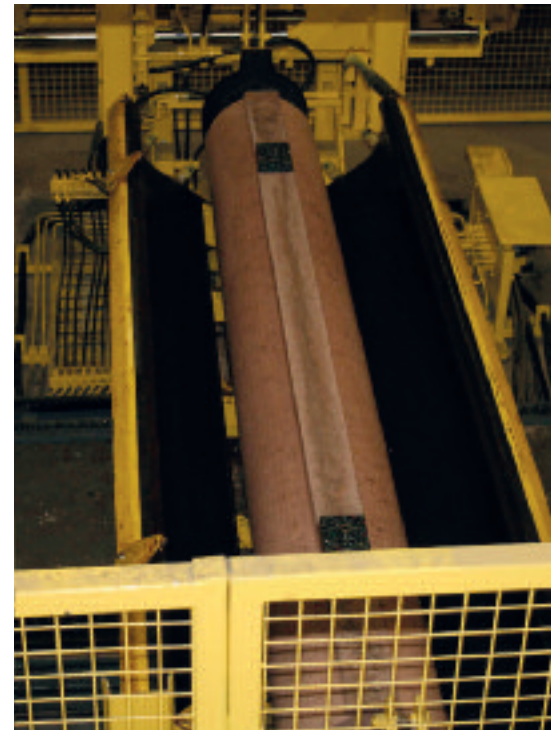
Proces rozformowania rury PERFECT PIPE.
