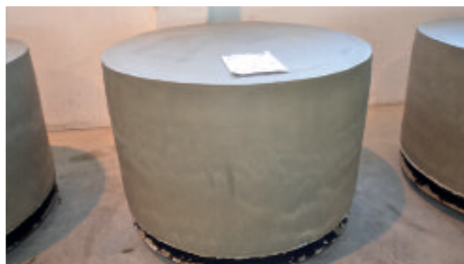
Półfabrykaty rozformowywane natychmiast po wyprodukowaniu są gotowe do frezowania.
