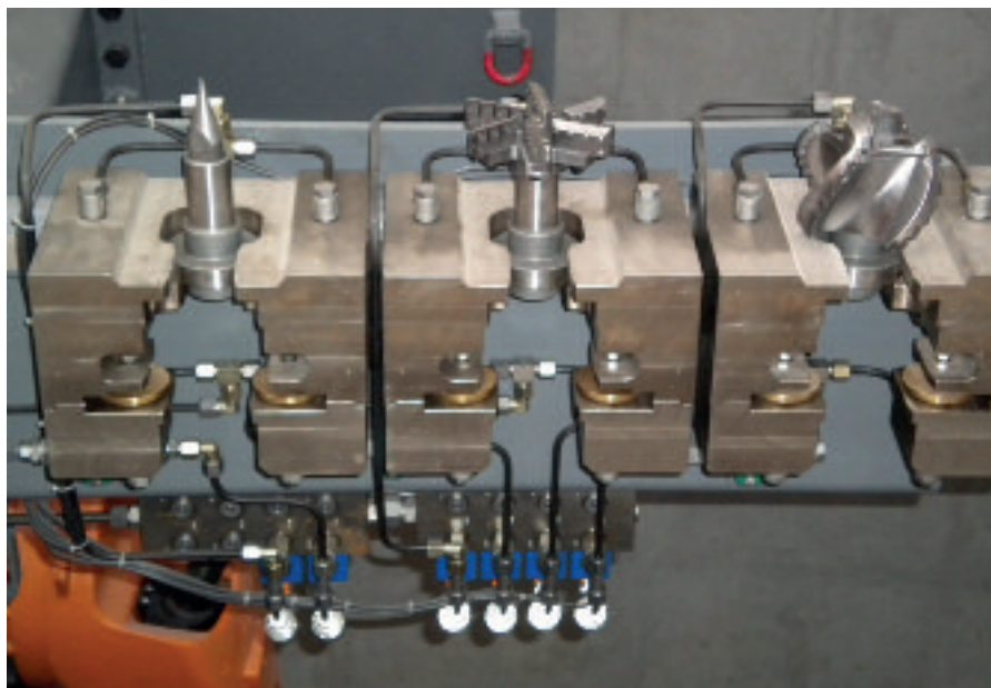
Zmieniarka narzędzi zawierająca do sześciu narzędzi frezujących i wiertniczych.
