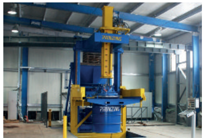
Bardzo krótki czas przezbrajania maszyny Tornado umożliwia produkcję różnych produktów na jednej zmianie, takich jak kręgi, zwężki i półfabrykaty podstaw studzienek.
