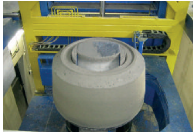
Produkcja zwężki na maszynie Tornado.
