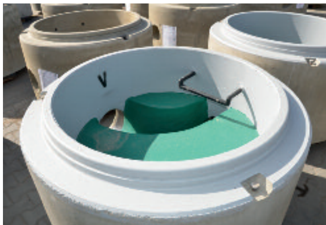
Kinety i przejścia szczelne są frezowane całkowicie automatycznie; wiercone są również otwory do umieszczenia stopni żłazowych.
