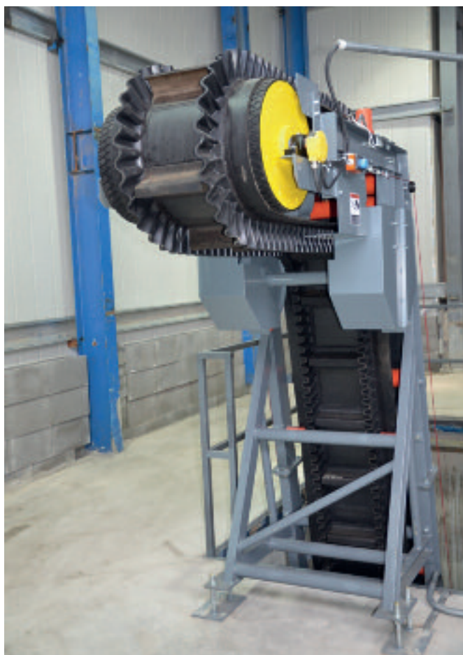
Przeñośnik kubekowy transportuje wyfrezowany materiał z dołu roboczego.
