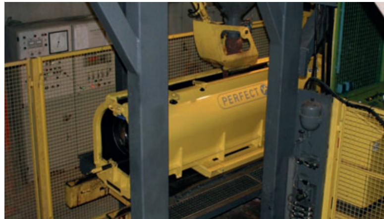
Durante la colata di calcestruzzo la forma è posizionata su una tavola mobile.
