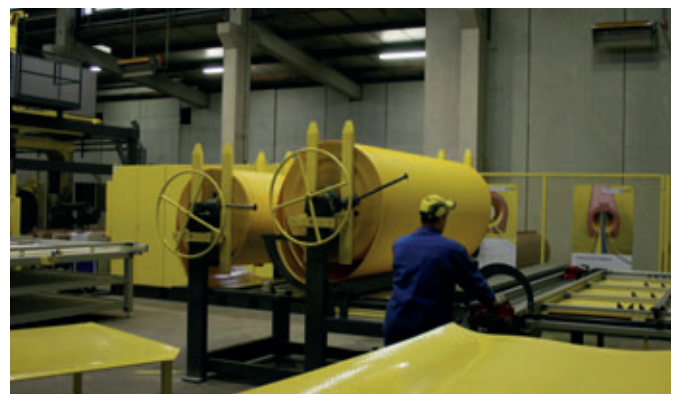
Taglio a misura della pellicola di PE dal rullo per la produzione dell'Inliner.
