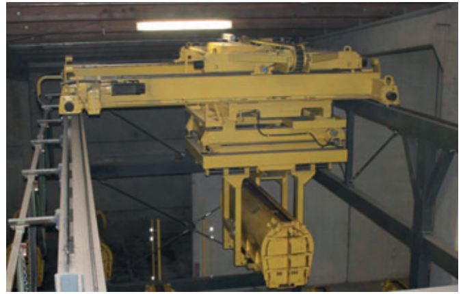
La gru robotizzata preleva la forma appena riempita e la posiziona sul Moving Floor System dell'area di indurimento.
