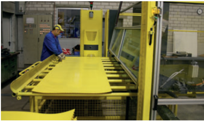
La pellicola di PE tagliata a misura viene alimentata all'impianto automatico di saldatura.
