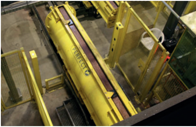
La forma riempita abbandona la stazione di colata di calcestruzzo.
