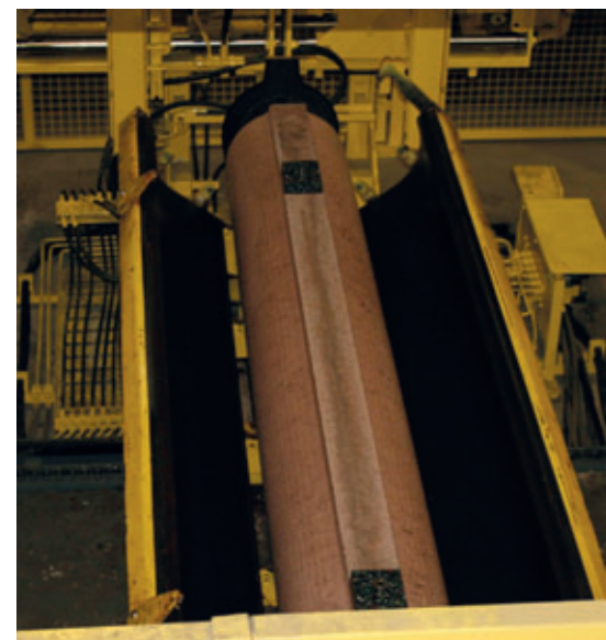
Processo di sformatura di un Perfect Pipe indurito.
