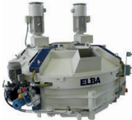
rents types de bétons. Ces malaxeurs sont utilisés là où il faut garantir la production de béton à long terme et sans accroc. Les malaxeurs sont disponibles dans différentes capacités. Le malaxeur à arbre simple ELBA EMS est disponible dans des capacités de 0,5 à 2,66 m<sup>3</sup> de béton durci, tandis que le malaxeur à deux arbres à palettes ELBA EMDW propose des capacités de 2 à 4,5 m<sup>3</sup> de béton durci.
