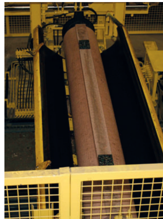
Démoulage d'un tuyau Perfect Pipe sec.
