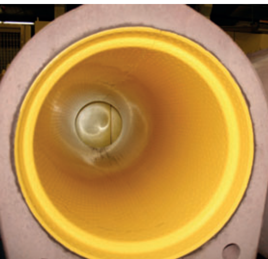
Tuyau à lit de pose lors du transport vers le parc extérieur.
