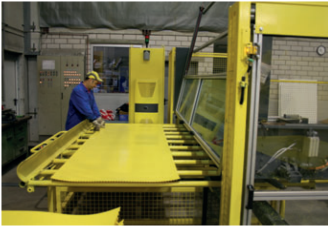
Le film PE découpé avec précision est poussé dans la machine à souder.
