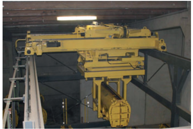
Le robot prend le moule fraîchement rempli et le place sur le système de plancher mobile de la zone de séchage.
