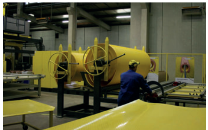
Découpe du film PE à partir du rouleau pour la fabrication de la chemise.
