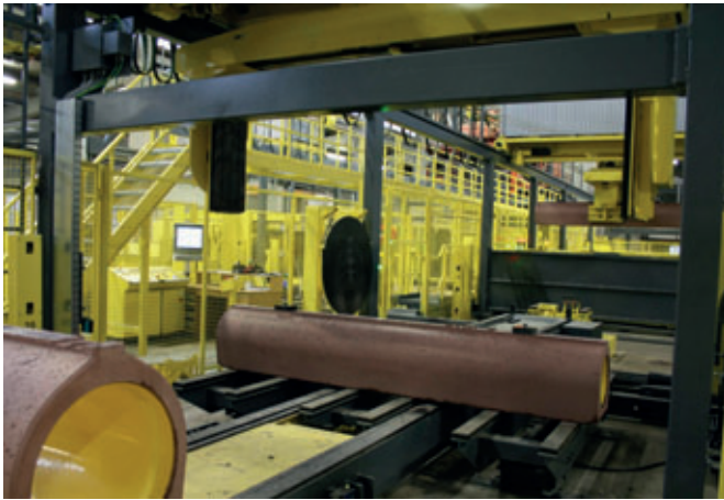
Avant de quitter la ligne de démoulage test d'étanchéité pour chaque tuyau.
