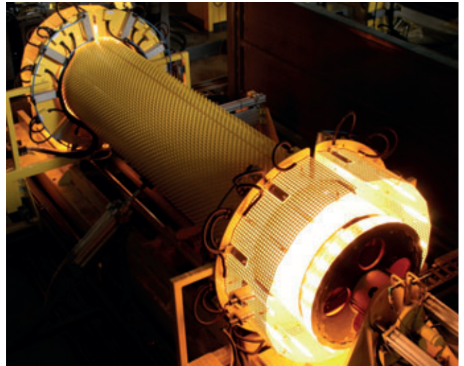
Processus de mise en forme thermoplastique pour la formation des embases.
