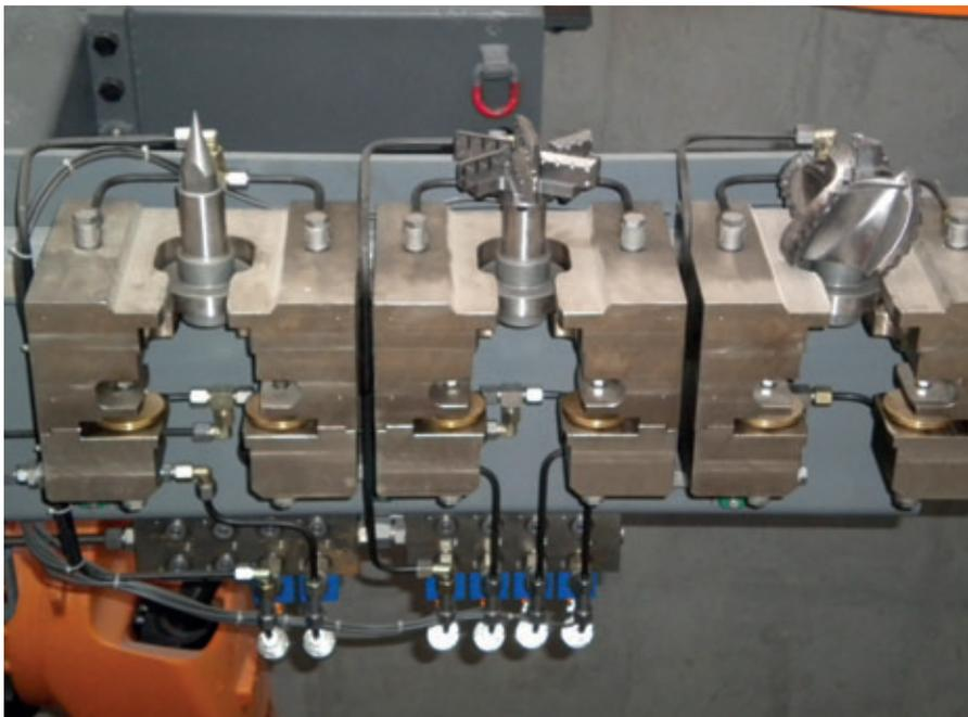
Le dispositif de changement d'outils avec jusqu'à sept outils de fraisage et de perçage
