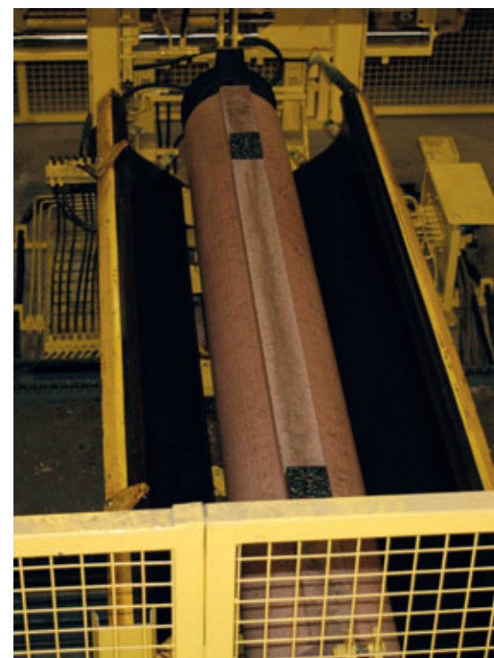
Entschalvorgang eines ausgehärteten Perfect Pipes
