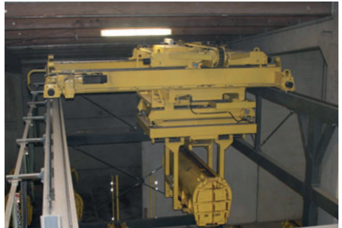
Der Kranroboter übernimmt die frisch befüllte Form und setzt sie auf dem Moving Floor System des Aushärtebereichs ab.
