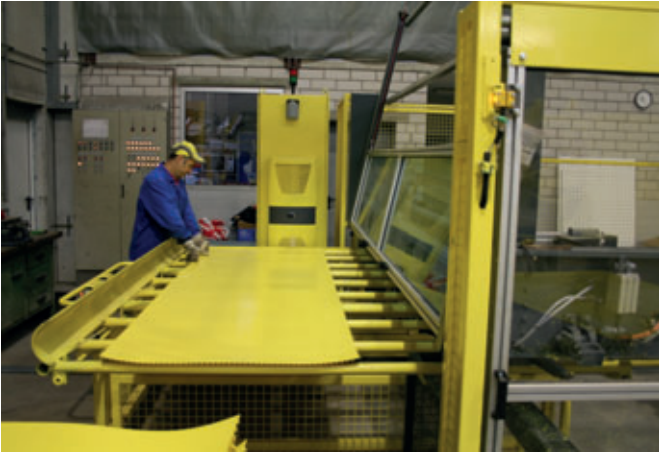
Die exakt zugeschnittene PE-Folie wird in den Schweißautomaten geschoben.
