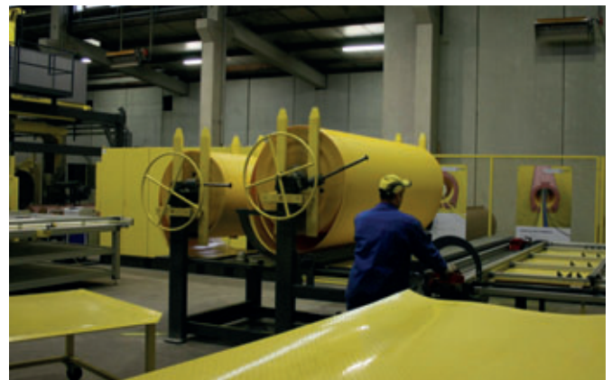
Ablängen der PE-Folie von der Rolle für die Herstellung der Inliner
