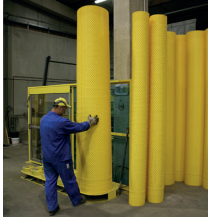
Die Zugfestigkeit der Schweißnaht kann unmittelbar nach abgeschlossenem Schweißvorgang überprüft werden.
