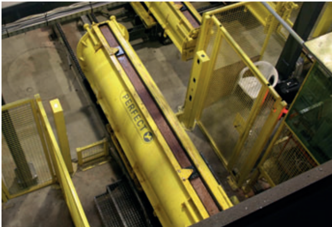
Befüllte Form verlässt die Betonierstation.
