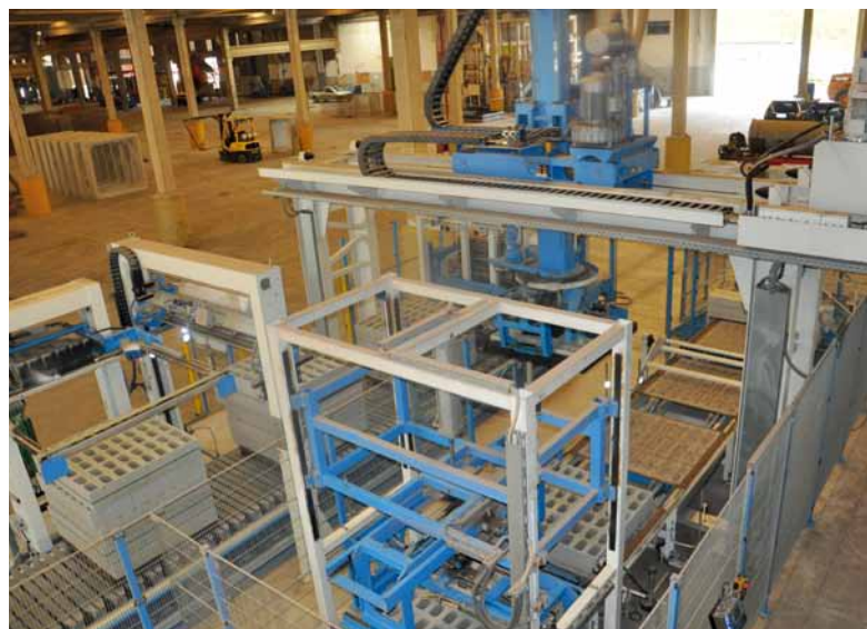
全自动伺服压块机将产品从生产台上移走，在卸货设备上将其包装成块状
