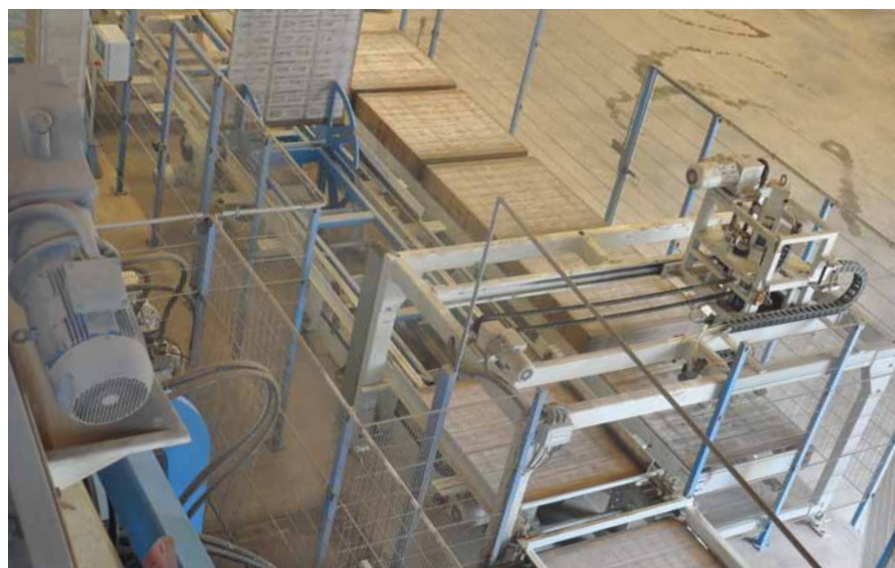
清洗后的平板经过翻转由横向运输机运往平台筒仓
