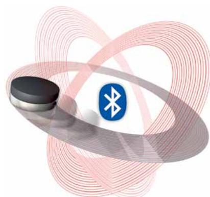
送和接收之间的无线电通讯数据使探头能够在带旋转搅拌槽的搅拌机和移动式散装物料集装箱内安装。工业上兼容蓝牙标准的使用，使操作可在恶劣环境条件下进行。
