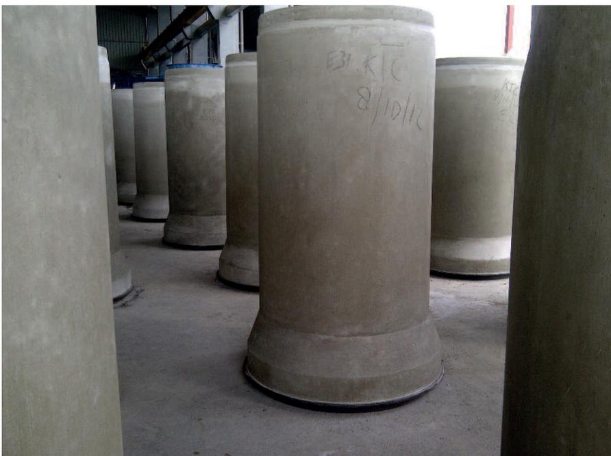
Бетонные трубы на участке сушки
