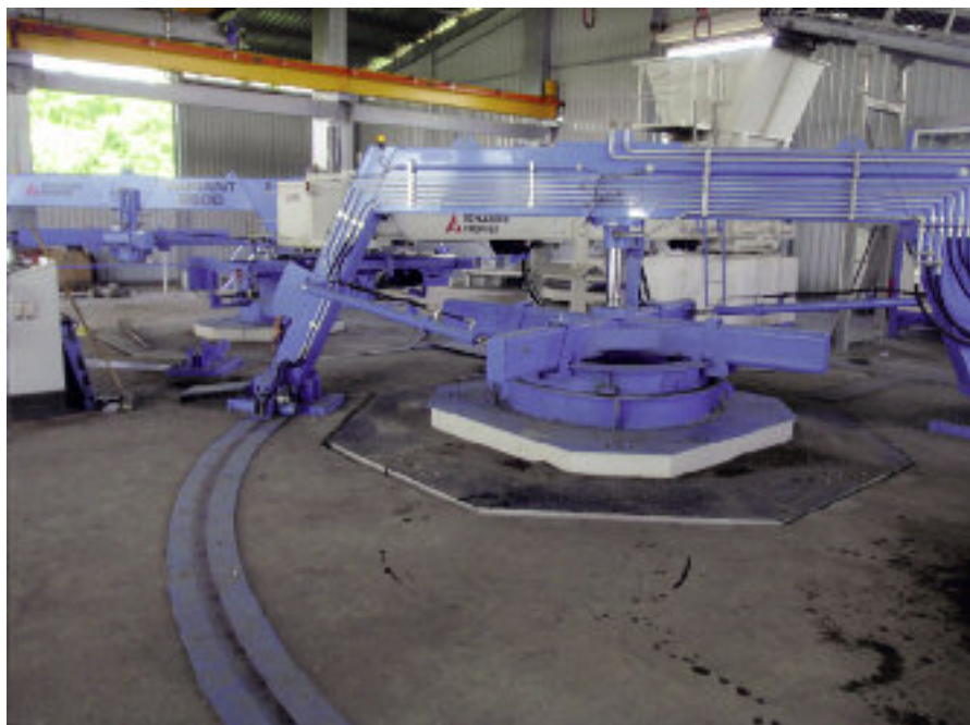
Głowica formująca bosy koniec wykonująca oscylujące ruchy obrotowe.
