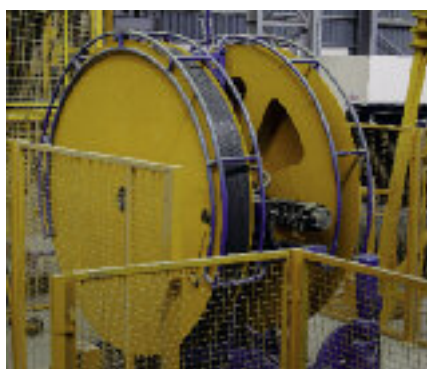
Używany do sprężonego zbrojenia drut zostaje dostarczany do maszyny w zwojach.
