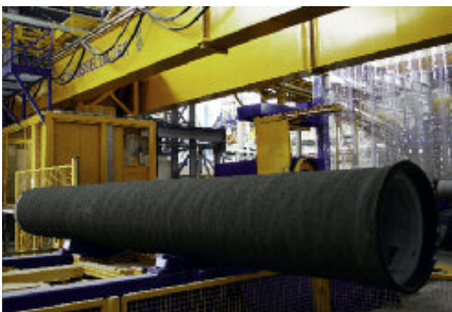
Betonowe rury ciśnieniowe mogą być produkowane z różnymi systemami połączeń. W przypadku tego projektu do formowania mufy i bosego końca używa się stalowych pierścieni.
