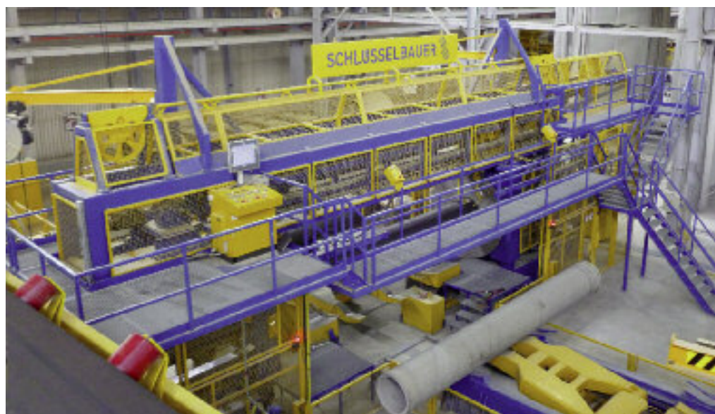
Skonstruowana i dostarczona przez firmę Schlüsselbauer maszyna do naciągu drutu zbrojeniowego pracuje z prędkością do 6 m/s.
