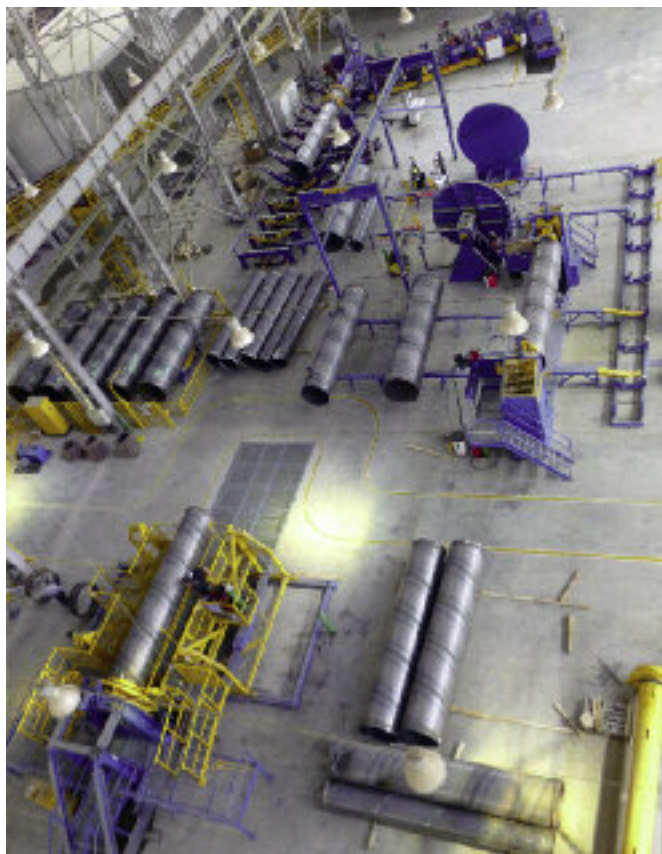
Dla zapewnienia szczelności ciśnieniowej rury betonowej stalowy cylinder jest automatycznie zwinany, spawany i kontrolowany. Jego długość jest odpowiednia dla każdego typu rury.
