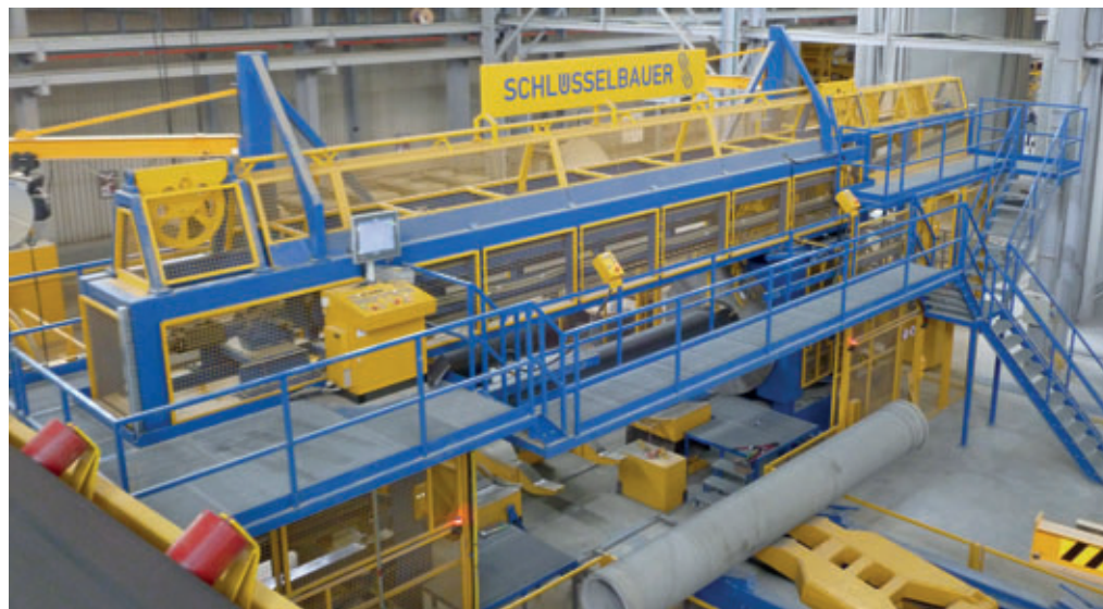
La macchina per la precompressione della Schlüsselbauer lavora con una velocità di avvolgimento fino a 6 m/s.
