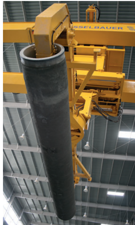
La gru automatica Transexact della Schlüsselbauer trasporta i prodotti finiti nelle camere di maturazione e infine sul nastro trasportatore. In seguito provvede alle coperture della camera di maturazione.
