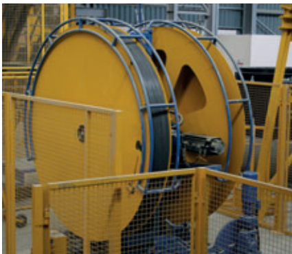
Il filo in acciaio, necessario alla precompressione, viene portato all'impianto in coil (rotolo) e lavorato poi con una velocità di avvolgimento fino a 6 m/s.
