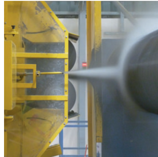
Nella fase conclusiva della lavorazione, si appone al tubo uno strato protettivo esterno con calcestruzzo centrifugato.
