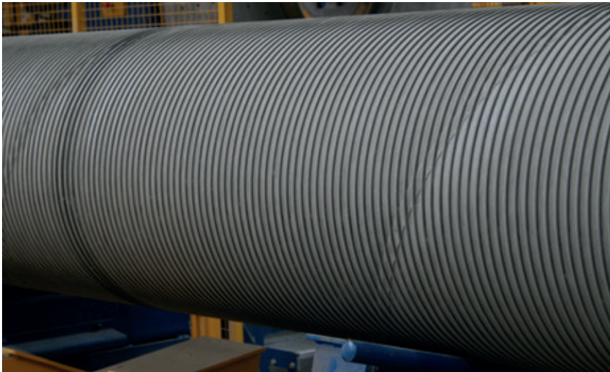
Sulla base della pressione di esercizio dei tubi in cemento precompresso, si stabiliscono la resistenza del filo, la precompressione e l'aumento dell'avvolgimento.
