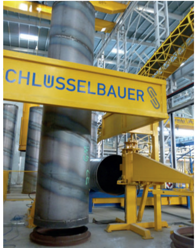
Per la manifattura del rivestimento interno in calcestruzzo umido, il cilindro in lamiera viene posto automaticamente su un manicotto e gettato in calcestruzzo secondo l'armatura dello stampo.
