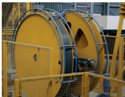
Le fil d'acier nécessaire pour la prétension est également mis en bobine sur le dispositif où il est traité avec une vitesse d'enroulement pouvant atteindre 6 m/s.
