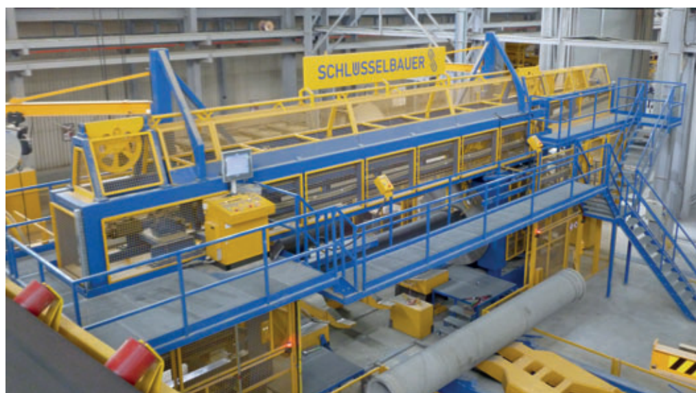
La machine de précontrainte développée par Schlüsselbauer fonctionne à une vitesse d'enroulement pouvant atteindre 6 m/s.
