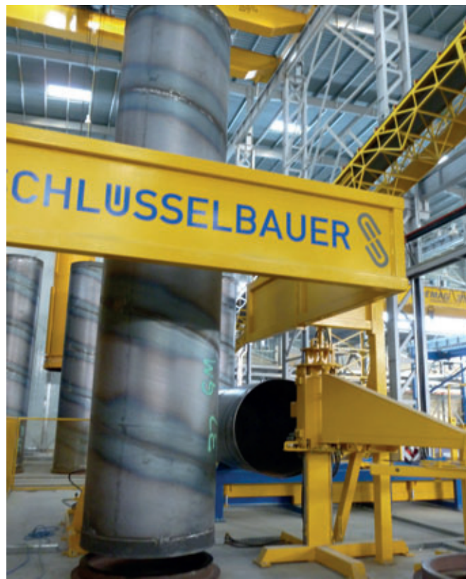
Pour la fabrication du revêtement intérieur du cylindre en béton humide, le cylindre en acier est automatiquement placé sur une embase remplie et bétonnée une fois le moule équipé.
