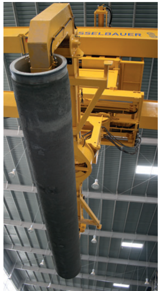
La grue automatique Transexact de Schlüsselbauer apporte les produits finis dans les étuves et ensuite sur le convoyeur. Elle assure également l'ouverture et la fermeture des couvercles des étuves.
