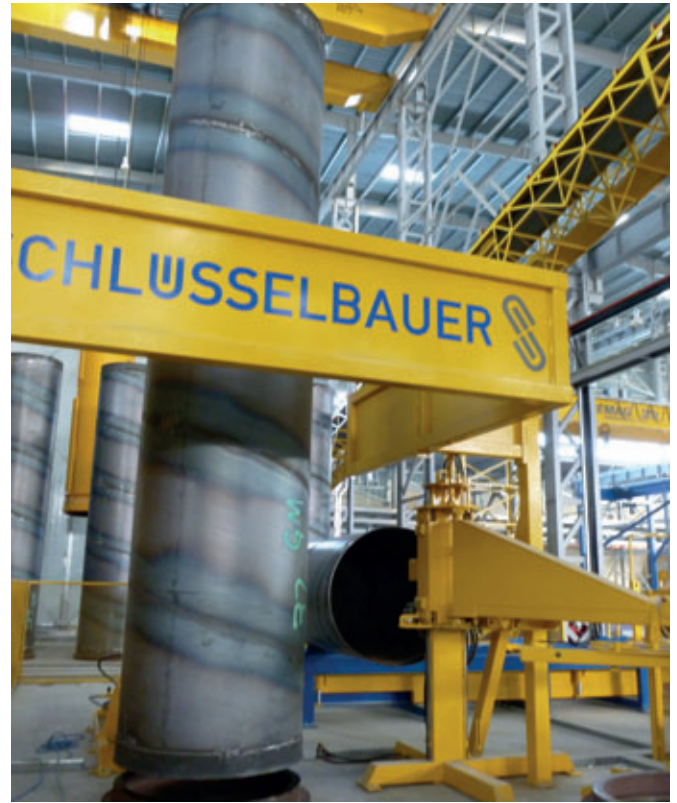
Para la fabricación del revestimiento interior a base de hormigón húmedo se coloca automáticamente el cilindro de chapa de acero en un manguito y se hormigona tras preparar el molde.
