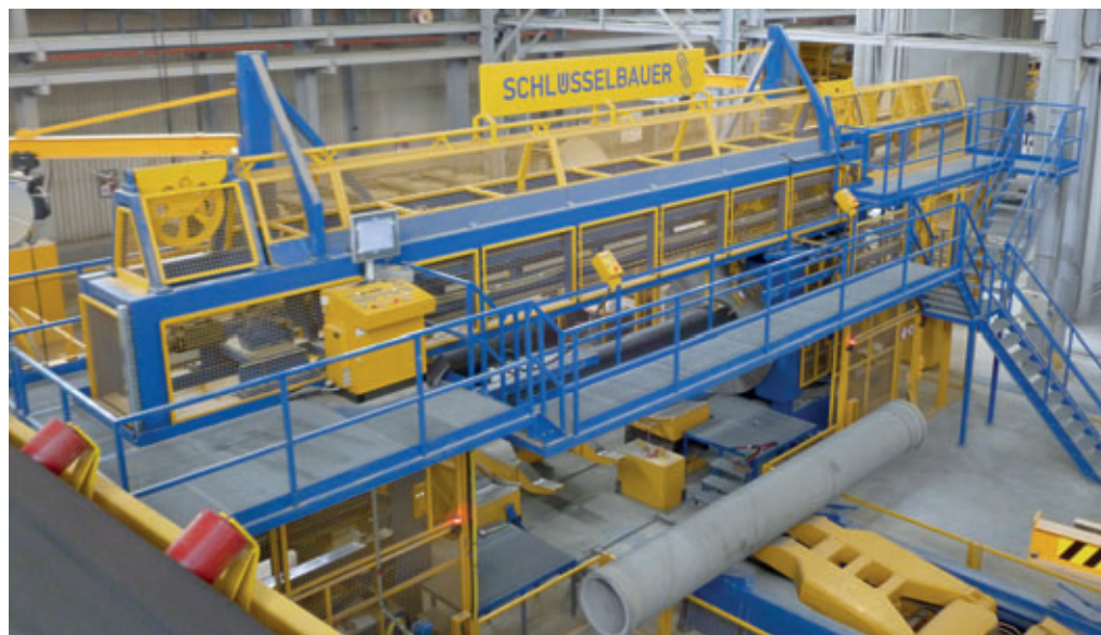
La máquina de pre-tensado desarrollada por Schlüsselbauer trabaja con una velocidad de bobina de hasta 6 m/s.
