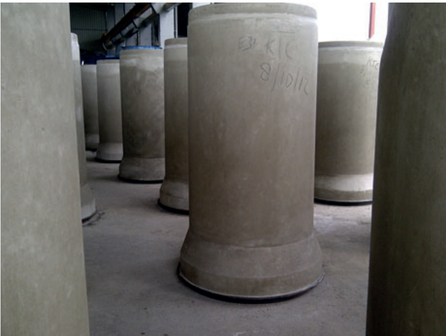
Tubo de hormigón en la zona de fraguado
