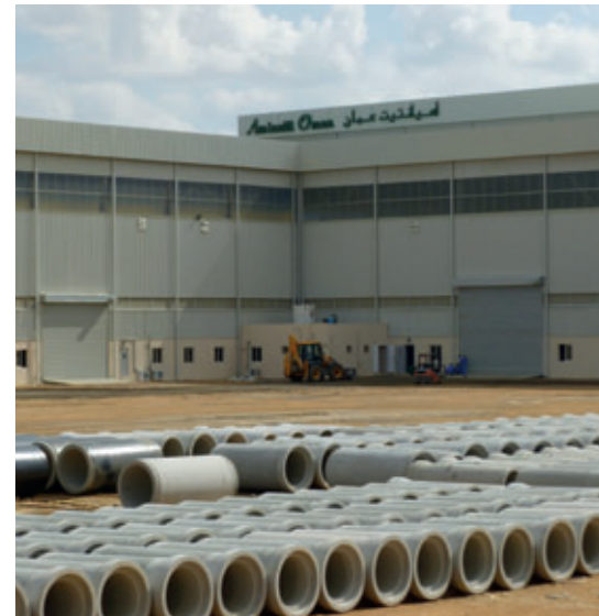
Neben Betondruckrohren werden auch Stahlbetonrohre der Nennweiten DN300 bis DN1800 sowie Beton-Vortriebsrohre hergestellt.
