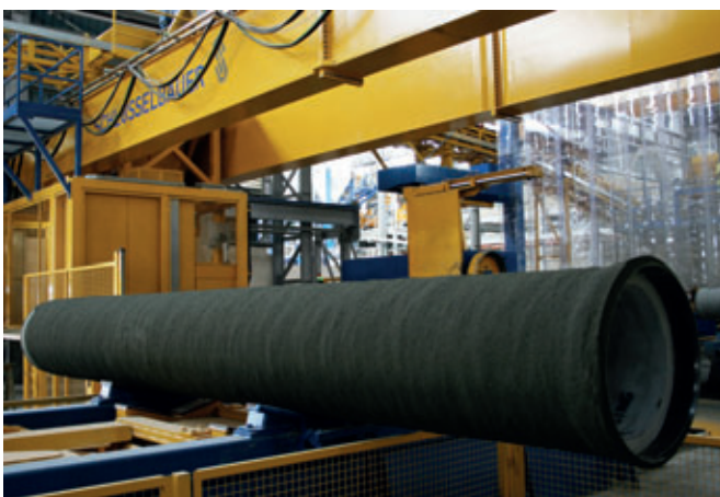
Betondruckrohre können mit unterschiedlichen Fügungen hergestellt werden. Im konkreten Projekt werden Muffen und Spitzenden mit Stahlendringen ausgeformt.
