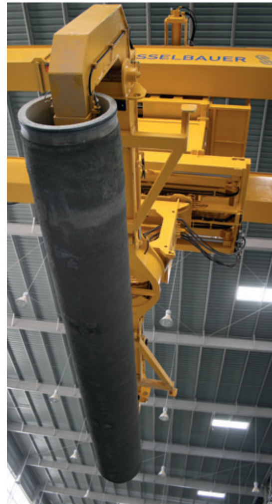
Der Automatikkrane Transexact von Schlüsselbauer bringt die Fertigprodukte in die Aushärtekammern und anschließend auf das Austrageförderband. Weiters bedient er die Abdeckungen der Kammern.
