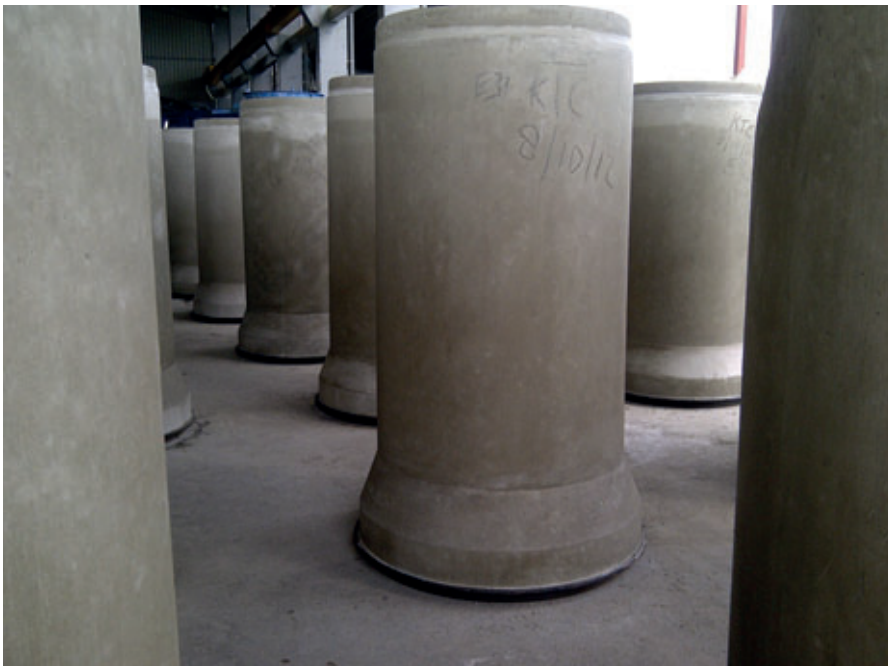
Betonrohre im Aushärtebereich
