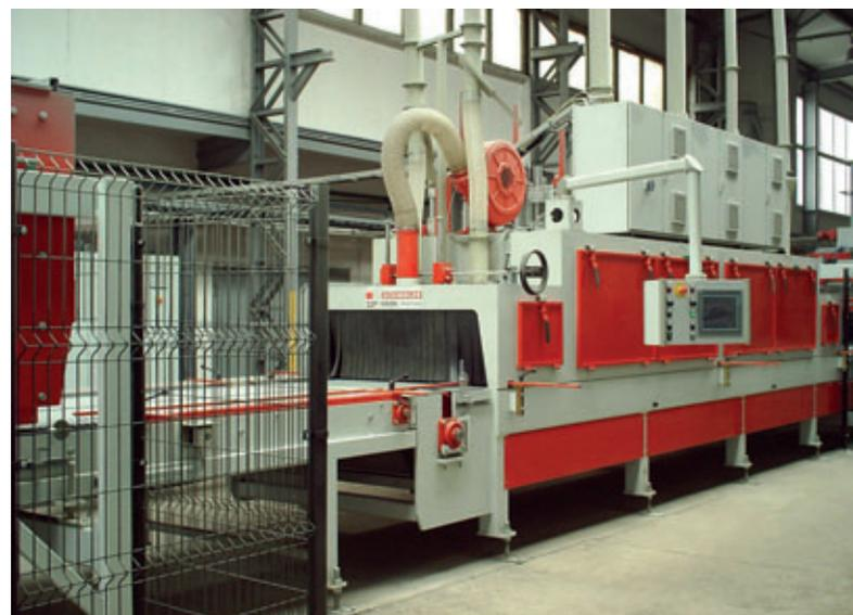
Curling-Anlage mit stationärem Bedienpanel
